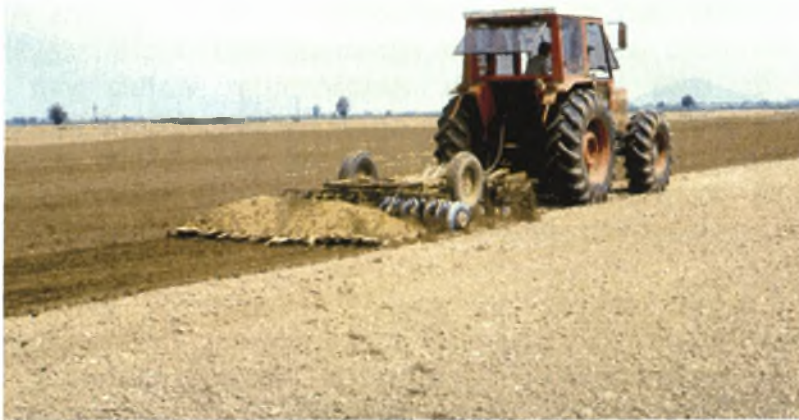
Εικόνα 7. Δισκοσβάρνα με ξύλινη πλεκτή σβάρνα
