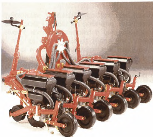
Εικόνα 8. Πνευματική μηχανή βαμβακιού.
