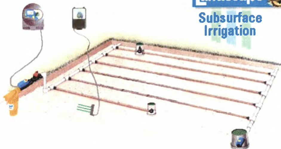
Εικόνα 18. Σύστημα υπόγειας στάγδην άρδευσης.
