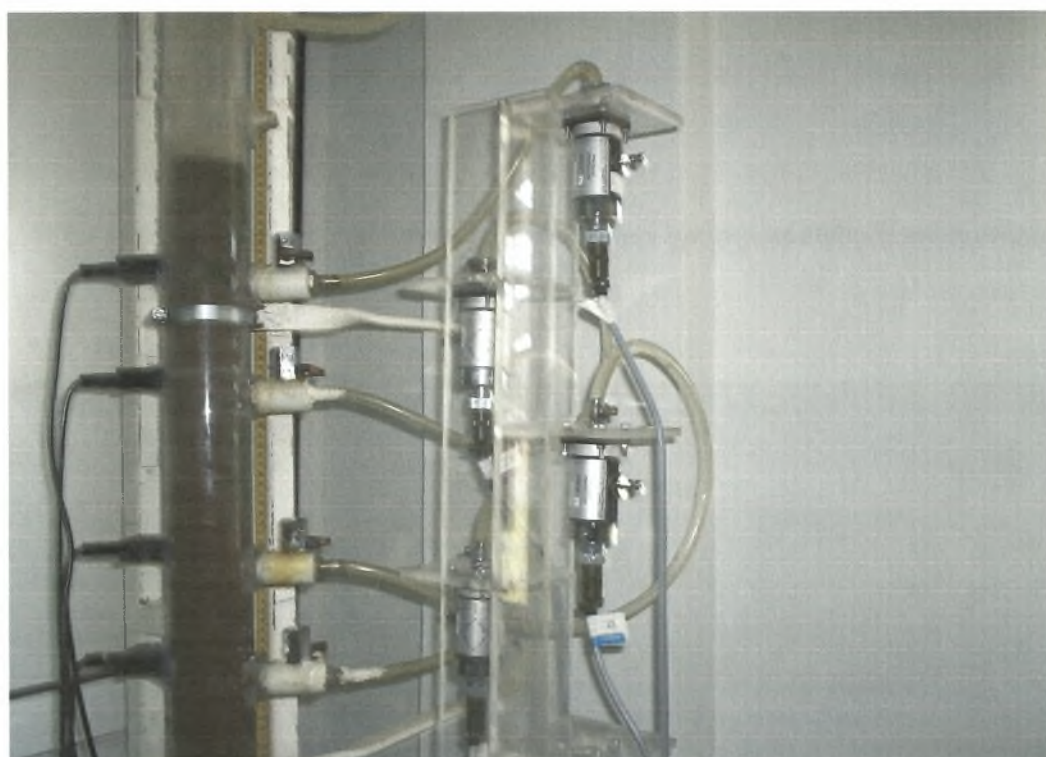
Εικόνα 2.5 Σύστημα κεραμικής κάψας – δεξαμενής νερού – εύκαμπτου σωλήνα όταν ήδη έχει συνδεθεί με την εδαφική στήλη και το μετατροπέα πίεσης.
