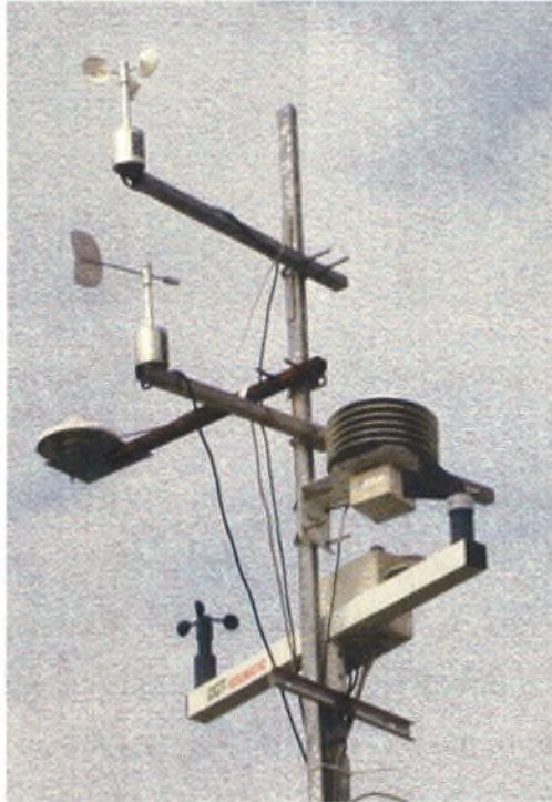
Σχήμα 3.4. Εξωτερικός μετεωρολογικός ιστός για την καταγραφή των εξωτερικών κλιματικών παραμέτρων.
