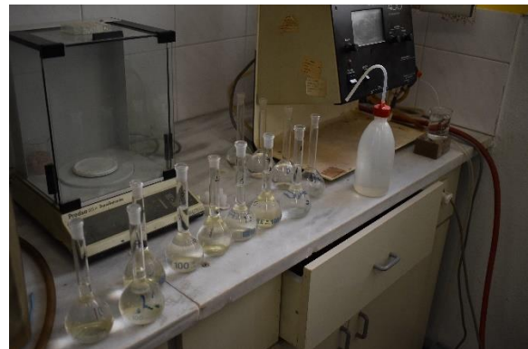
Εικόνα 34. Τα διαλύματα (Standard και διαλύματα εδαφών) έτοιμα για το φλογοφωτόμετρο (Φωτογραφία: Σ. Στεφανόπουλος).
