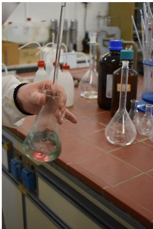
Εικόνα 37. Διάλυμα H_2SO_4 0,1N από το σιφώνιο προς την κωνική φιάλη ανά σταγόνα έως όπου γίνει από πράσινο μωβ (Φωτογραφία: Σ. Στεφανόπουλος).
