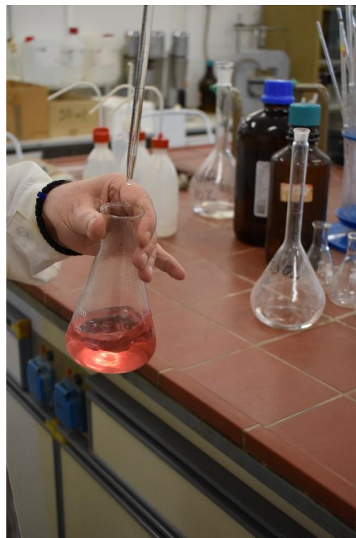
Εικόνα 38. Μετατροπή του διαλύματος από πράσινο σε μωβ. Ογκομέτρηση του διαλύματος που ξοδεύτηκε (Φωτογραφία: Σ. Στεφανόπουλος).
