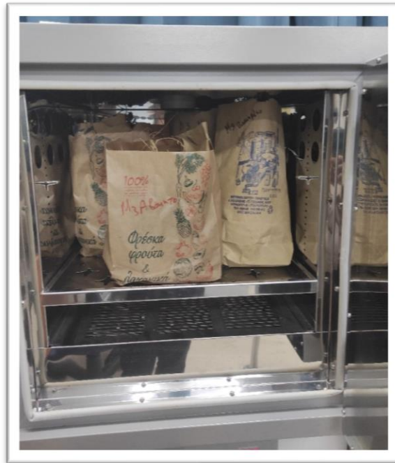
Εικόνα 58. Δείγματα λιβαδικής παραγωγής προς ξήρανση στους 68° C για 48 ώρες (Φωτογραφία: Σ. Στεφανόπουλος).
