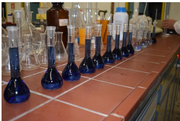
Εικόνα 41. Προσθέτοντας, σταγόνα-σταγόνα, σε κάθε φιάλη διάλυμα του \text{H}_2\text{SO}_4 5N, το διάλυμα από κίτρινο αποχρωματίζεται (Φωτογραφία: Σ. Στεφανόπουλος).
