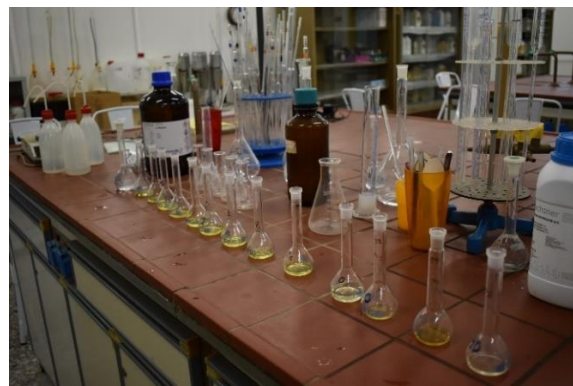
Εικόνα 40. Αφού διηθηθεί, προστίθεται 1 σταγόνα δείκτη p-nitrophenol και λαμβάνουν κίτρινο χρώμα (Φωτογραφία: Σ. Στεφανόπουλος).
