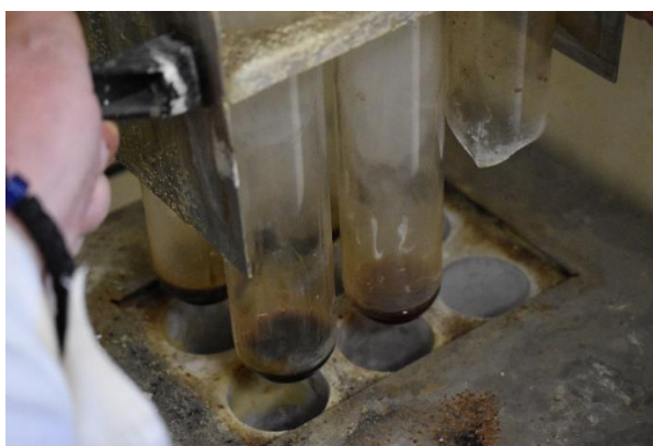
Εικόνα 35. Συσκευή πέψης Kjeldahl τύπου VELP. Τοποθετημένο 1g εδάφους και 5ml σαλικυλικού οξέος και στη συνέχεια καταλύτης και κρυσταλλικό θειοθειικό νάτριο (Φωτογραφία: Σ. Στεφανόπουλος).
