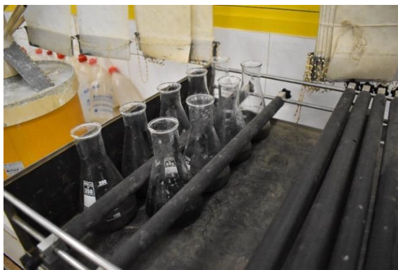
Εικόνα 39. Έδαφος και διάλυμα \text{NaHCO}_3 1N μπαίνουν στην συσκευή για 30 λεπτά (Φωτογραφία: Σ. Στεφανόπουλος).
