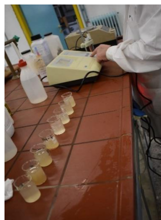
Εικόνα 30. Παραλαβή του εκχυλίσματος και μέτρηση στο αγωγιμόμετρο (Φωτογραφία: Σ. Στεφανόπουλος).
