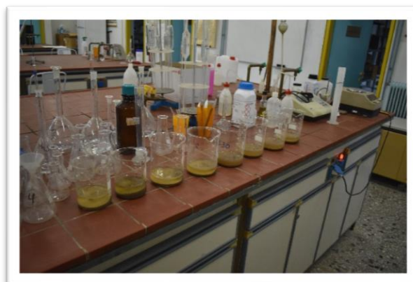
Εικόνα 20. Ποτήρια ζέσεως με 50g εδάφους από κάθε δείγμα και 40ml \text{NaPO}_3 (μεταφωσφορικό Νάτριο) (Φωτογραφία: Σ. Στεφανόπουλος).
