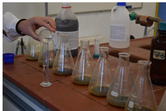
Εικόνα 26. Προσθήκη 20ml πυκνού \text{H}_2\text{SO}_4 μέσα στο διάλυμα (Φωτογραφία: Σ. Στεφανόπουλος).
