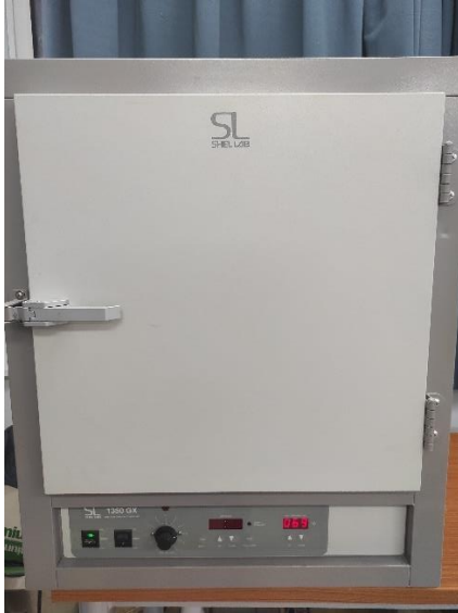
Εικόνα 56. Κλίβανος αποξηράνσης λιβαδικής παραγωγής. Μοντέλο: Shel Lab 1350 GX του Εργαστηρίου Λιβαδοπονίας και Διαχείρισης Προστατευόμενων Περιοχών, Τμήμα ΔΕΞΥΣ (Φωτογραφία: Σ. Στεφανόπουλος)
