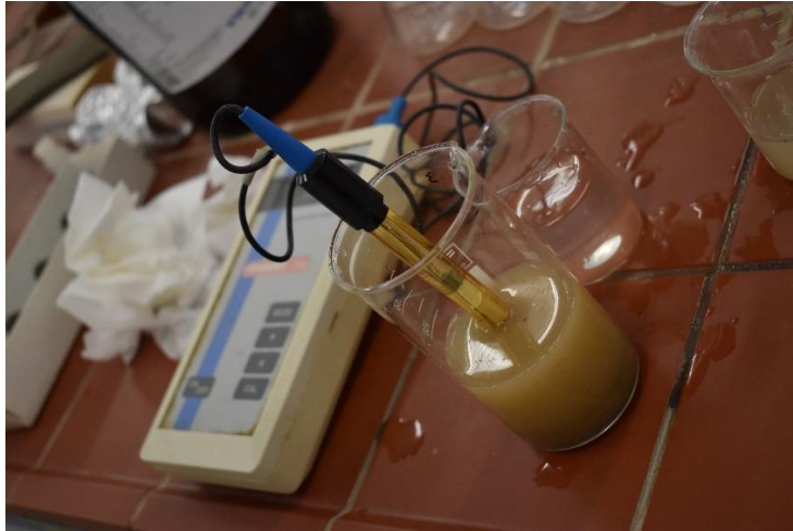
Εικόνα 24. Ρύθμιση του πεχάμετρου με ρυθμιστικά διαλύματα τιμών pH 7, 9 και 4 και τέλος, μέτρηση του pH του αιωρήματος (Φωτογραφία: Σ. Στεφανόπουλος).
