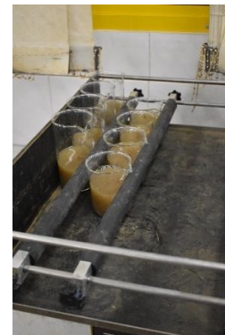
Εικόνα 23. Ανάδευση για 5 λεπτά με ράβδο και στη συνέχεια για μισή ώρα στον αναδευτήρα (Φωτογραφία: Σ. Στεφανόπουλος).
