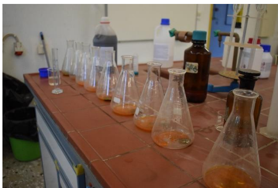
Εικόνα 25. Προσθήκη 1g εδαφικού δείγματος σε κωνική φιάλη 500ml και διάλυμα \text{K}_2\text{Cr}_2\text{O}_7 1N (49,04g/L) (Φωτογραφία: Σ. Στεφανόπουλος).
