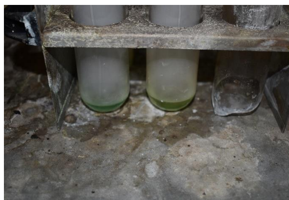
Εικόνα 36. Το διάλυμα της φιάλης μέχρι να γίνει διαυγές πράσινο η συσκευή παραμένει σε λειτουργία (Φωτογραφία: Σ. Στεφανόπουλος).
