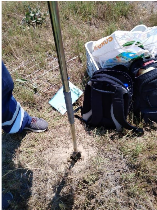
Εικόνα 11. Δειγματοληψία εδάφους με ειδικό δειγματολήπτη σε βάθος 0 – 25cm (Φωτογραφία: Ι. Καζόγλου)
