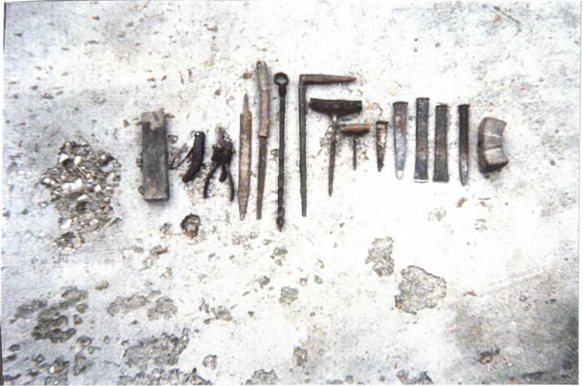
Διακρίνονται από αριστερά: ακώνι, σουγιάς, τσαπράκι, ξυλοφάι, πριάκονο, αρίδα φαλάδρα, αμόνι, αρίδα μεγάλη, αριδάκι, ζουμπάς, σουφλοκόπιδο, καλέμι, χτενιά, σουφλοκόπιδο, ματρακάς
