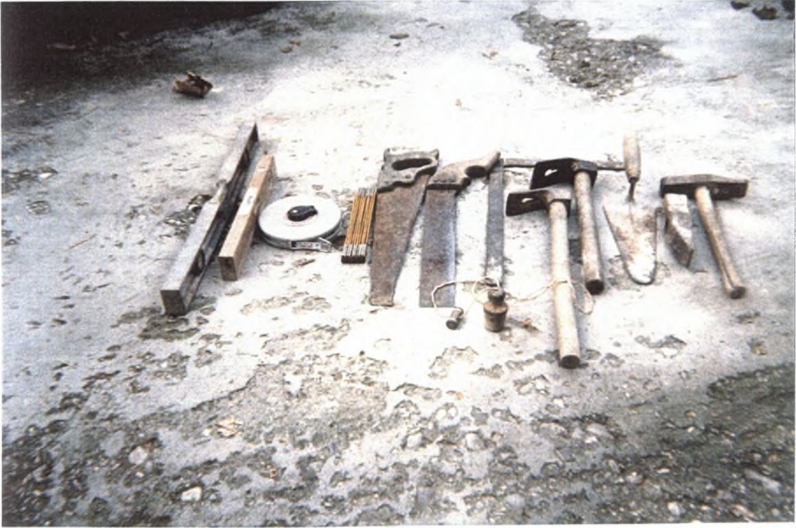
Διακρίνονται από αριστερά: αλφάδι ίσο, αλφάδι κρεμαστό, κορδέλα, μέτρο, σεγάτσα, χειροπρίονο, γωνιά, σκεπάρι στενό, σκεπάρι φαρδύ, μιστρί, τσόκι μεγάλο, τσόκι μικρό. Μπροστά από τη γωνιά διακρίνεται το ζύγι.
