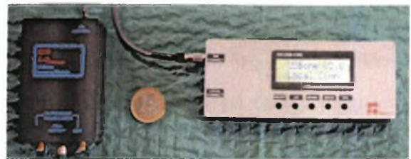
ΕΙΚ. 45. Φορητή συσκευή για την ευόδωση και παρακολούθηση της πώρωσης με LiUS. Αριστερά φαίνεται το δομοστοιχείο παραγωγής και λήψης υπερήχων (Sensing Module, SM) και δεξιά το δομοστοιχείο ελέγχου (Control Module, CM). Η συσκευή μπορεί να βρίσκεται συνεχώς πάνω στον ασθενή (wearable device).
