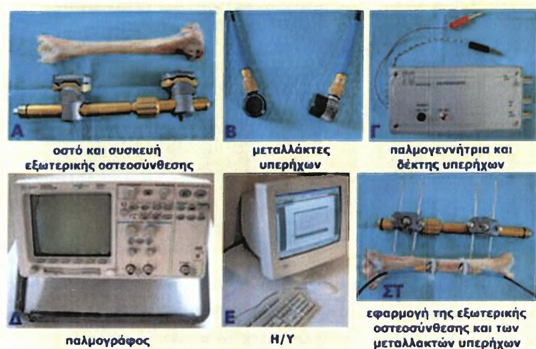
Εικ. 39. Στην εικόνα παρουσιάζονται τα επιφέρους στοιχεία της πειραματικής διάταξης για τη μελέτη της διάδοσης των υπερήχων στα οστά *in vitro*.
