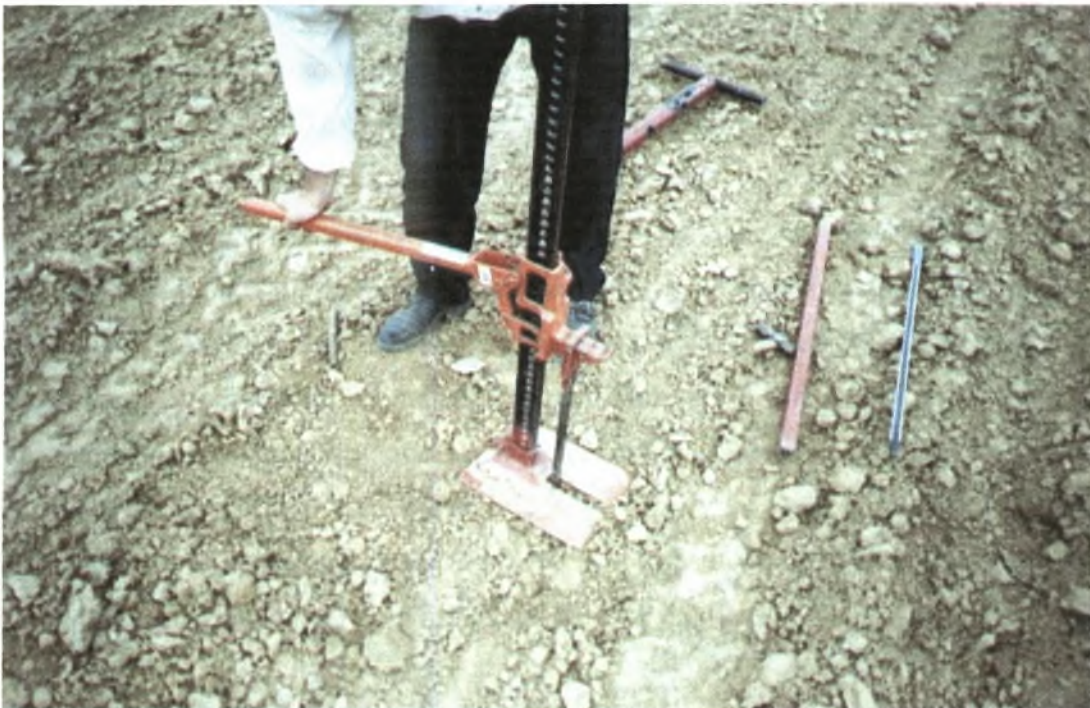
Εικόνα 6.3. Εργαλείο που χρησιμοποιήθηκε για την είσοδο του αισθητήρα στο έδαφος
