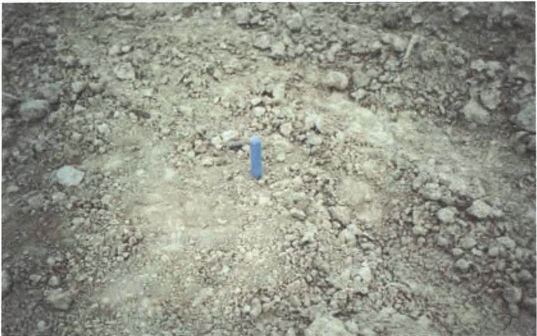
Εικόνα 6.1. Αισθητήρας TDR που χρησιμοποιήθηκε στο πείραμα
