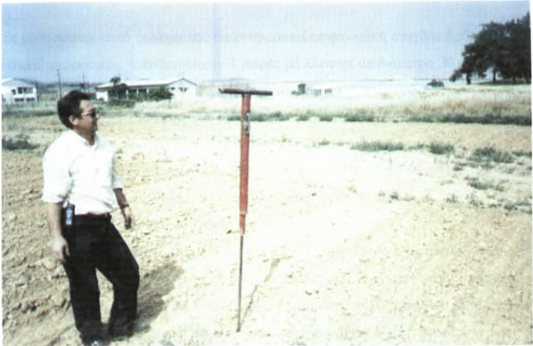
Εικόνα 6.2. Εργαλείο που χρησιμοποιήθηκε για τη διάνοιξη τρύπας μέσα στην οποία θα τοποθετηθεί ο αισθητήρας
