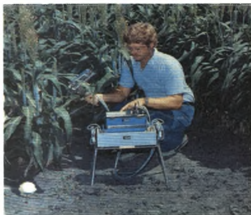
Εικ 15,16 : μέτρηση ρυθμού αφομοίωσης CO 2 , εξοπλισμός Εργαστηρίου Γεωργίας
