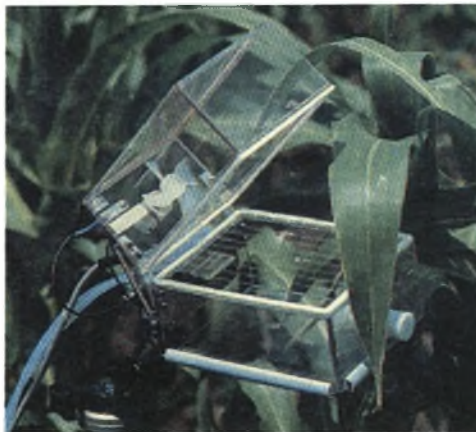
Εικ 15,16 : μέτρηση ρυθμού αφομοίωσης CO 2 , εξοπλισμός Εργαστηρίου Γεωργίας
