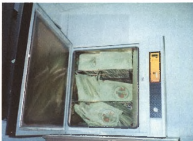
Εικ 12 : κλίβανος για ξήρανση φυτών στο Εργ. Γεωργ. Μηχανολογίας.
