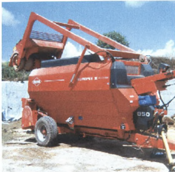
Εικόνα 14: Μηχάνημα εφαρμογής T.M.R (total mixed ratio) διατροφής.
