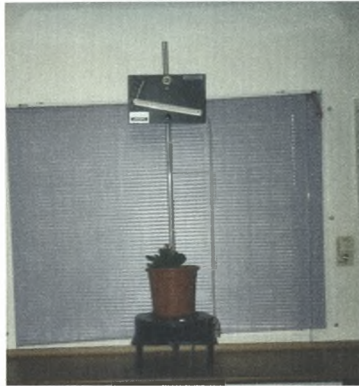
Εικόνα 1: Το σύστημα του λυσιμέτρου με τη γλάστρα
