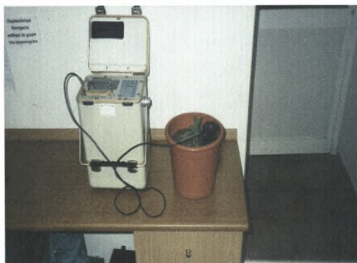
Εικόνα 8: Η μέτρηση της εδαφικής υγρασίας με τη μέθοδο του TDR.
