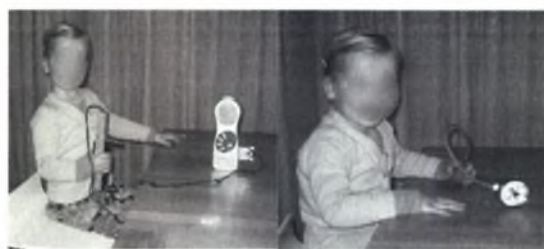
Εικόνα 5: Ένα τετράχρονο παιδί χρησιμοποιώντας αριστερά το δυναμόμετρο Lode και δεξιά το Martin vigorimeter.
