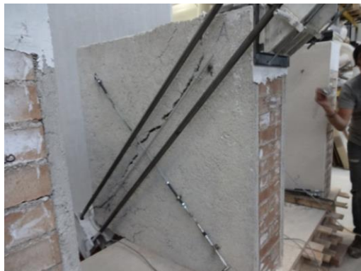
Σχήμα 4-6 Αστοχία ενισχυμένου δοκιμίου (Borri et al., 2015)
