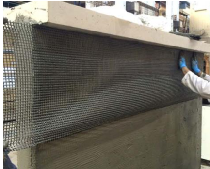
Σχήμα 2-57 Εφαρμογή υφάσματος IAM (Koutas et al., 2019)
