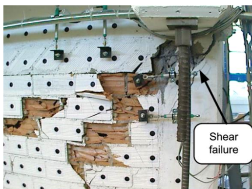
Σχήμα 2-55 Αστοχία δοκιμίου ελέγχου (Koutas et al., 2015)
