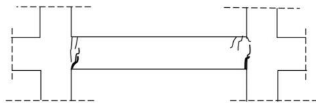
Σχήμα 2-6 Ανάπτυξη καμπτικών ρωγμών στο άνω πέλμα και ολίσθηση οπλισμού στο κάτω (Δρίτσος, 2005)
