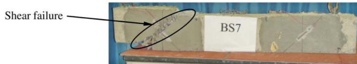
Σχήμα 2-18 Τυπική διατμητική αστοχία (Al-Salloum et al., 2012)
