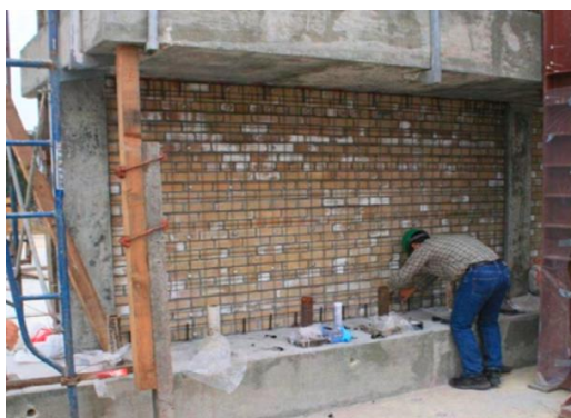
Σχήμα 2-23 Οπλισμένη τοιχοποιία σε πλαίσιο ΟΣ (Koutromanos et al., 2011)
