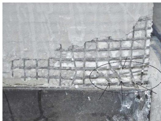
Σχήμα 4-9 Αστοχία ενισχυμένου δοκιμίου (Triantafillou et al., 2017)
