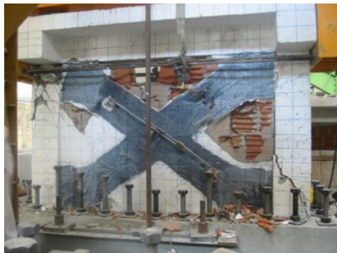
Σχήμα 2-49 Αστοχία ενισχυμένου δοκιμίου (Erol et al., 2015)
