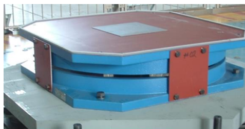
Σχήμα 2-25 Διάταξη εφέδρανου ολίσθησης (Warn et al., 2012).
