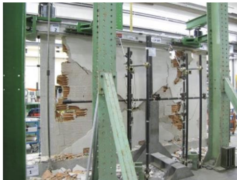
Σχήμα 2-44 Αποτέλεσμα συνδυαστικής καταπόνησης σε τοιχοπλήρωση (da Porto et al., 2015)
