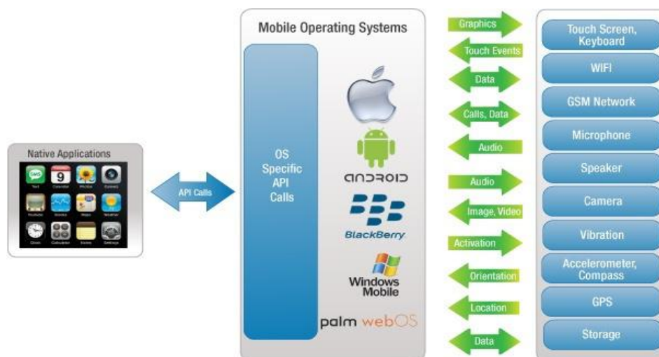
Εικόνα 6. Περιγραφή της αλληλεπίδρασης των λειτουργιών της συσκευής με τις εγγενούς εφαρμογές.
