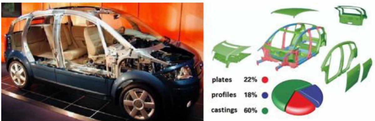
Εικόνα 2.6 Συστατικά μέρη από αλουμίνιο στο μοντέλο A2 της εταιρείας Audi [18].
