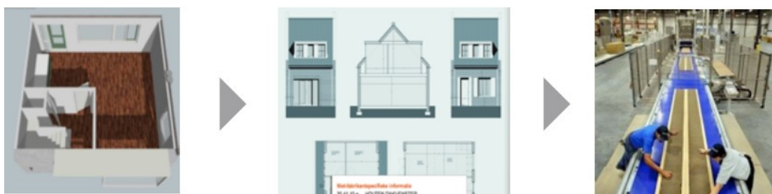
Εικόνα 15. Τρισδιάστατη σάρωση-> το BIM παράγει τα τεχνικά σχέδια -> το εργοστάσιο παράγει προκατασκευασμένες λύσεις
