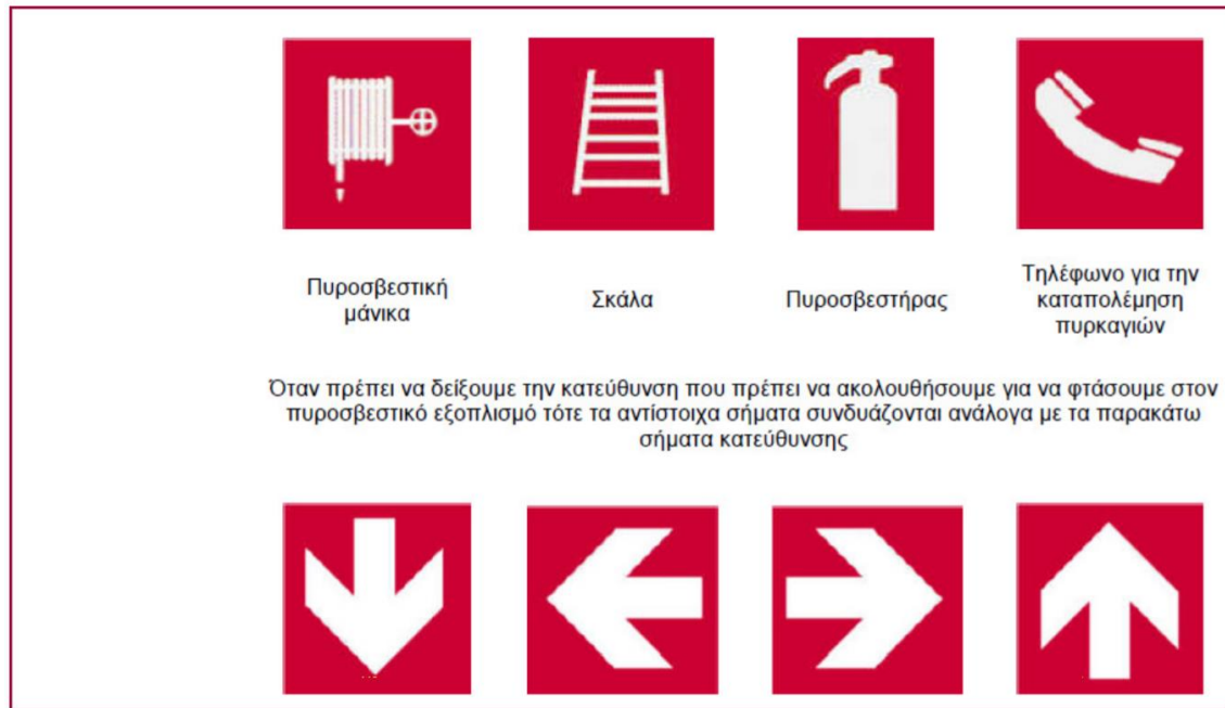
Εικόνα 14: Πινακίδες που αφορούν το πυροσβεστικό υλικό ή εξοπλισμό (Πηγή: ΕΛ.ΙΝ.Υ.Α.Ε.)
