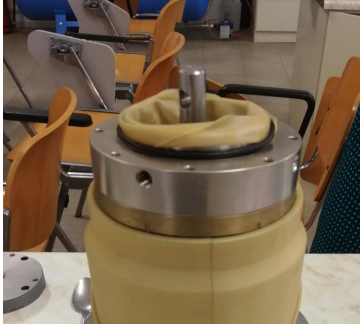
Σχήμα 3.21: Η εσωτερική και η εξωτερική μεμβράνη διπλώνονται και ασφαλίζονται με ελαστικούς δακτυλίους στη διάταξη διαμόρφωσης του δοκιμίου άμμου.
