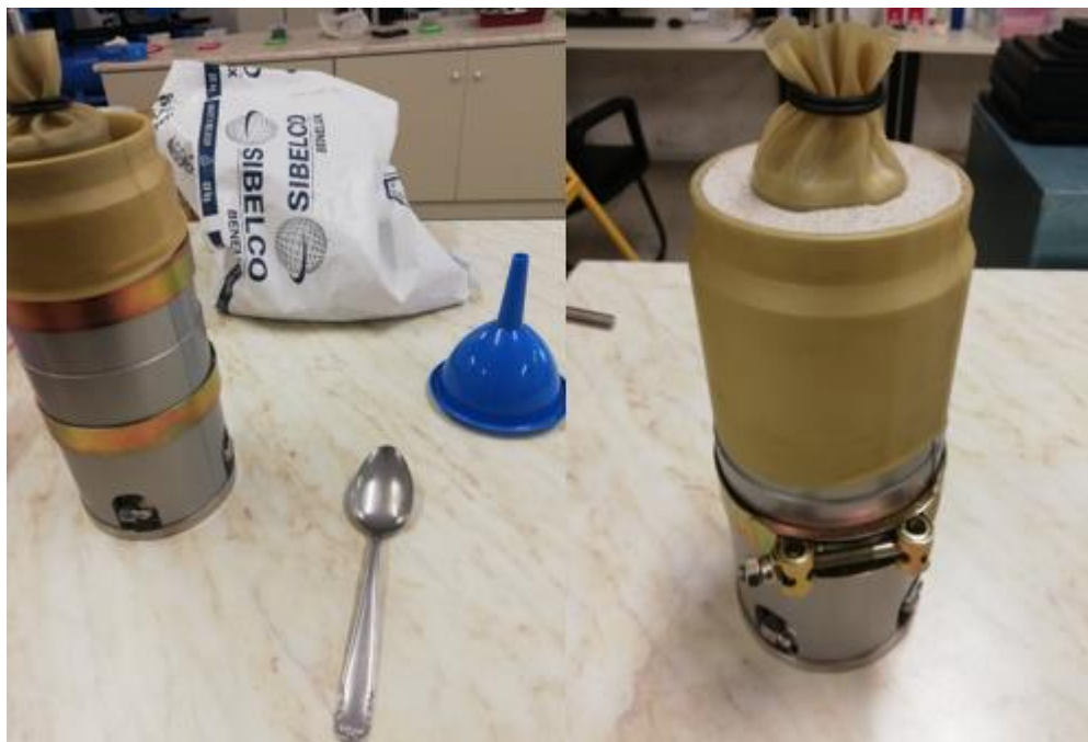
Σχήμα 3.19: Έγχυση της άμμου σε στρώσεις στην κοιλότητα μεταξύ των δύο μεμβρανών, με τη βοήθεια ενός χωνιού και ενός κουταλιού.
