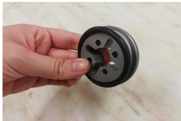
Σχήμα 3.9: Τοποθέτηση του ελαστικού δακτυλίου στη βάση του άνω εξαρτήματος συγκράτησης της εσωτερικής μεμβράνης.
