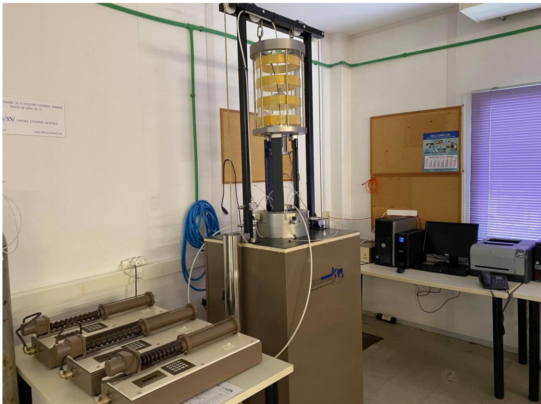
Σχήμα 3.1: Η συσκευή GDS ss - HCA στον χώρο του εργαστηρίου Γεωτεχνικής Μηχανικής του Πανεπιστημίου Θεσσαλίας.
