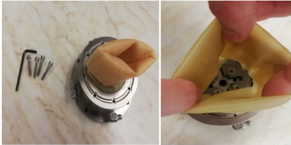
Σχήμα 3.12: Σφράγιση μεταξύ της εσωτερικής μεμβράνης και της βάσης του δοκιμίου με 4 βίδες.
