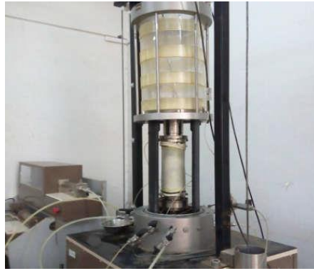
Σχήμα 4.76: Συσκευή στρεπτικής διάτμησης κόιλου κυλινδρικού δοκιμίου της εταιρείας GDS (Zhenglong et al., 2017).
