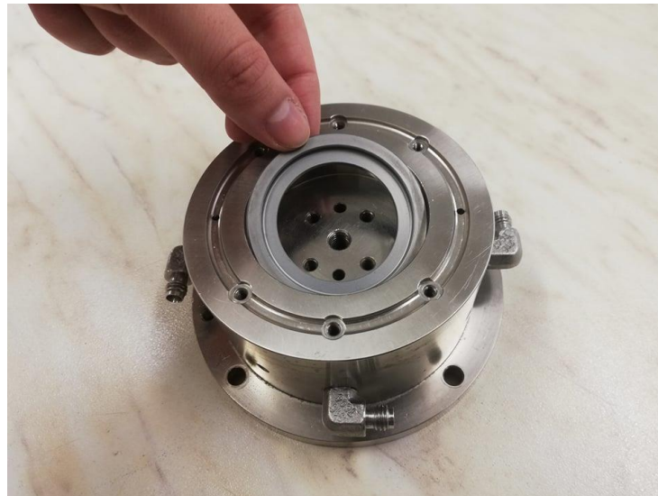
Σχήμα 3.8: Τοποθέτηση του κάτω δακτυλίου συγκράτησης της εσωτερικής μεμβράνης στο εσωτερικό της βάσης του δοκιμίου.
