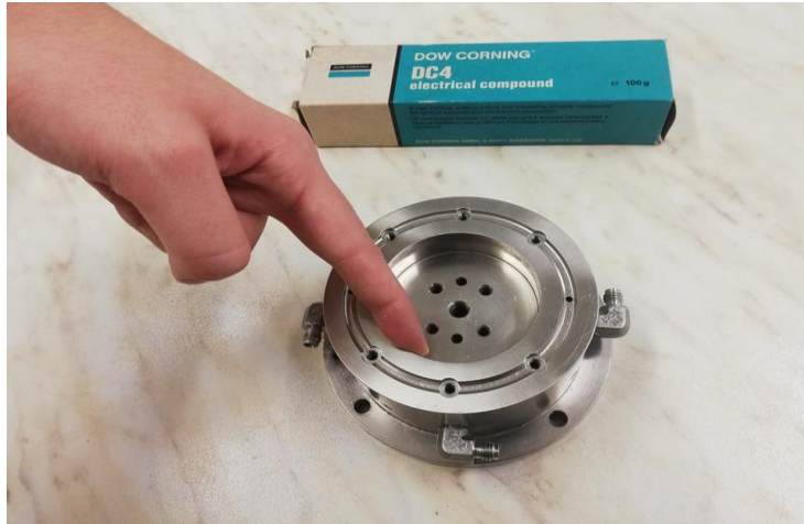
Σχήμα 3.7: Τοποθέτηση λιπαντικού στο εσωτερικό χείλος της βάσης του δοκιμίου.
