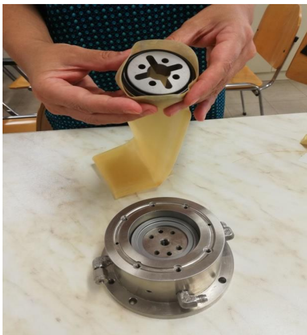
Σχήμα 3.10: Τοποθέτηση της διάταξης δακτύλιος-άνω εξάρτημα συγκράτησης της εσωτερικής μεμβράνης εντός της εσωτερικής μεμβράνης.
