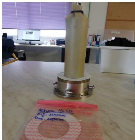
Σχήμα 3.16: Τοποθέτηση του φίλτρου στον πορώδη δίσκο της βάσης του δοκιμίου.
