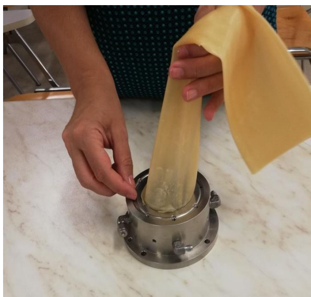
Σχήμα 3.11: Τοποθέτηση της διάταξης δακτύλιος – άνω εξάρτημα συγκράτησης της εσωτερικής μεμβράνης – εσωτερική μεμβράνη στο εσωτερικό της βάσης του δοκιμίου.
