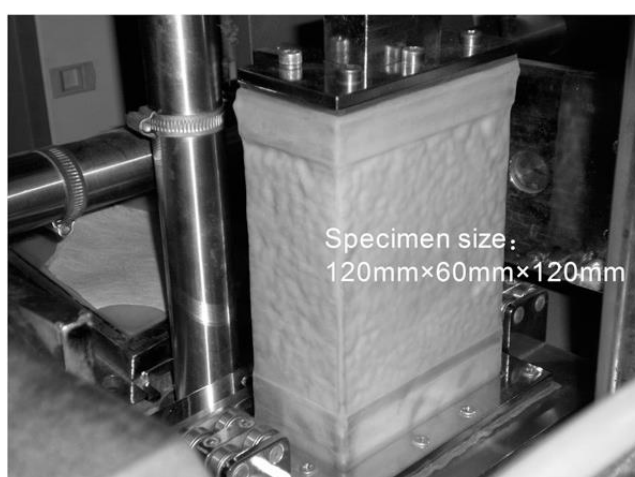
Σχήμα 4.54: Εγκατάσταση του εδαφικού δοκιμίου στην τριαξονική συσκευή (Xiao et al., 2014).
