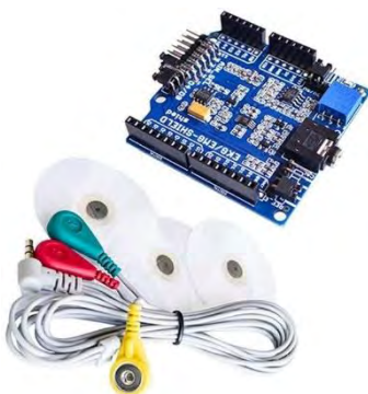
Πλακέτα Arduino με ηλεκτρόδια παραλαβής σήματος
