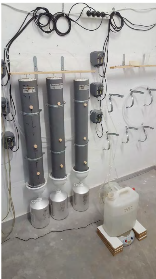
Εικόνα 11. Τρεις στήλες έκπλυσης σταθεροποιημένες στον τοίχο σε όρθια θέση. Στην εικόνα φαίνονται τα χωνιά και τα δοχεία συλλογής του εκπλύματος, οι περισταλτικές αντλίες στον τοίχο, και το δοχείο των 15 L με το υγρό απόβλητο.
