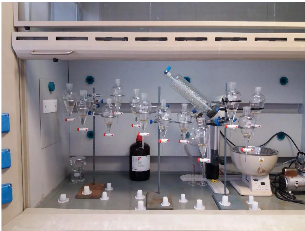
Εικόνα 12. Διαχωριστικές χοάνες στις οποίες έχει προστεθεί το δείγμα και το χλωροφόρμιο. Πίσω από τις χοάνες, φαίνεται το ο περιστροφικός εξατμιστήρας (Rotary Evaporator) και η αντλία κενού στα δεξιά του.
