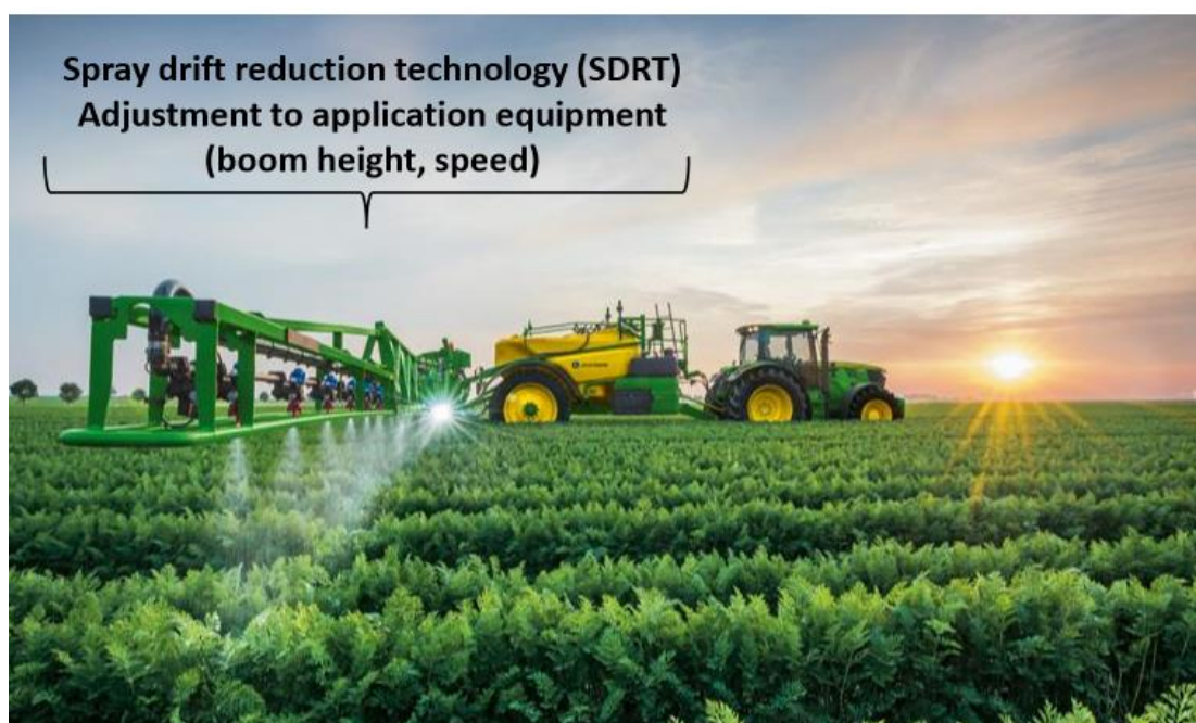
Εικόνα A7-3: Τεχνολογία SDRT προσαρτημένη σε ψεκαστικό μηχάνημα (πηγή: www.deere.com )
