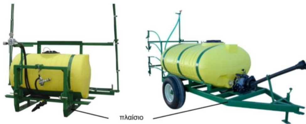
Εικόνα Α5-5: Ελκόμενο ψεκαστικό μηχανήμα στην υδραυλική ανάρτηση του γεωργικού ελκυστήρα (αριστερά) και φερόμενο ψεκαστικό μηχανήμα ( δεξιά) (Γέμτος, Θ., Καβαλάρης, Χ. 2015).
