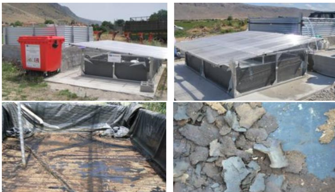
Εικόνα A11-10: Εγκατεστημένα συστήματα Heliosecc (πάνω) και στερεά υπολείμματα φυτοπροστατευτικών προϊόντων μετά των τέλος της αφυδάτωσης (κάτω) Πηγή: Επίσημη ιστοσελίδα της Syngenta ( https://www.syngenta.gr/stewardship/heliosecc )
