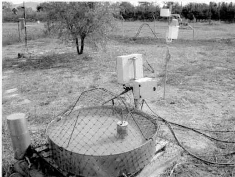
Εικόνα 4.2: Μετεωρολογικός σταθμός και εξατμισόμετρο τύπου Α.
