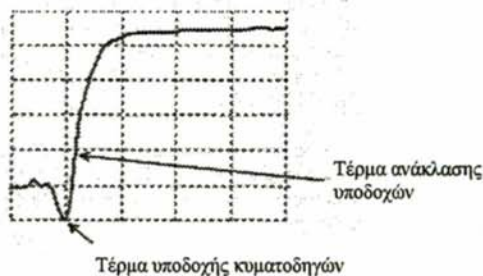
Σχήμα 2.5: Υποδοχή κυματοδηγών (connector), χωρίς συνδεδεμένους κυματοδηγούς.
