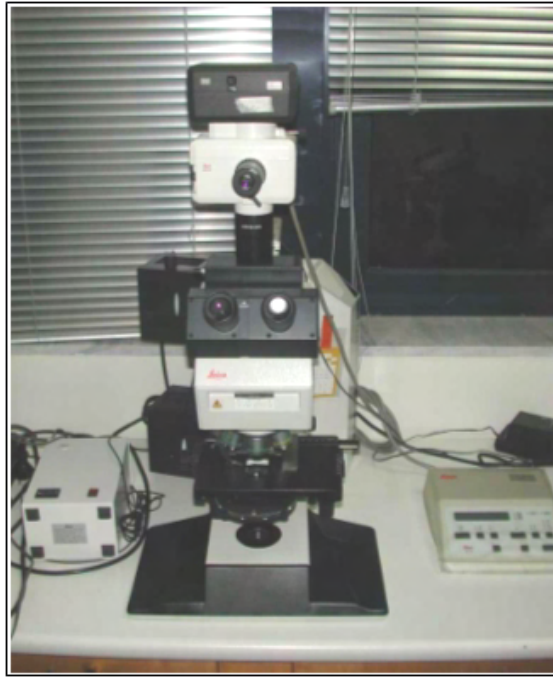
Εικόνα 3. Μικροσκόπιο αντίθεσης φάσης για μέτρηση μορφολογικών χαρακτηριστικών της αφίδας Aphis gossypii
