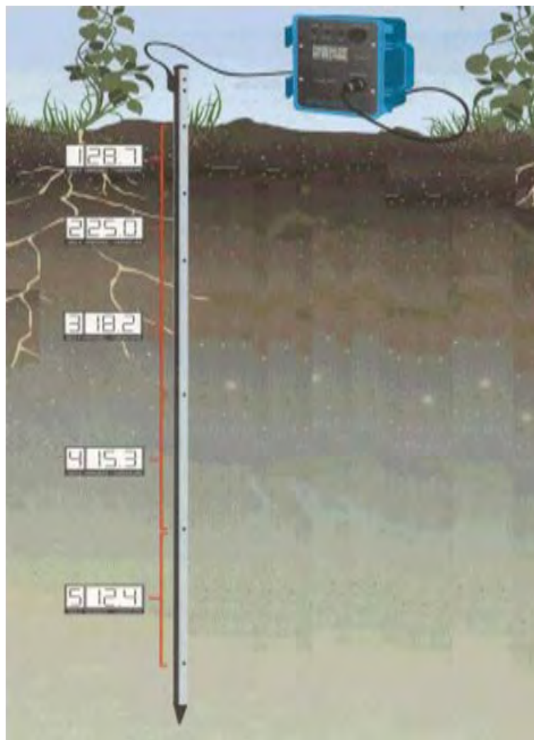
Εικόνα 3.9: Η διάταξη μέτρησης εδαφικής υγρασίας Moisture Point.
