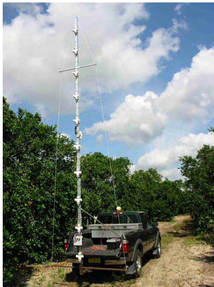
Εικόνα 2.13. Σύστημα μέτρησης του όγκου των δένδρων με υπερήχους
