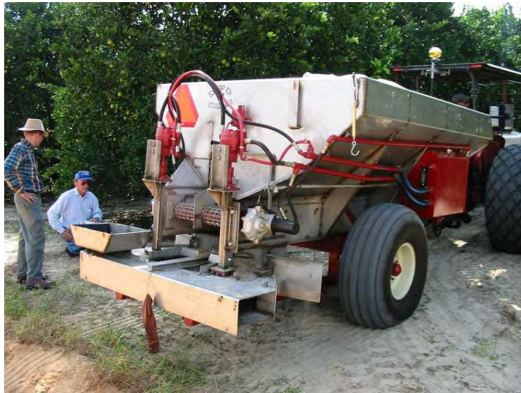
Εικόνα 2.14. Λιπασματοδιανομέας για την εφαρμογή λιπάσματος με μεταβλητές δόσεις
