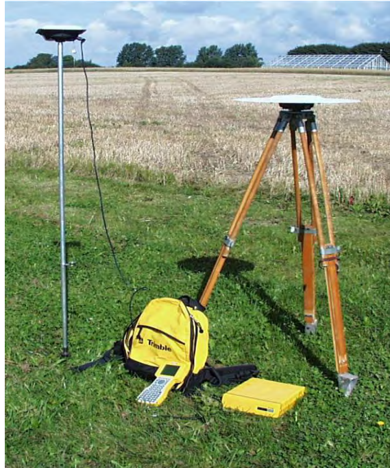
Εικόνα 2.3 Real Time Kinematic GPS
