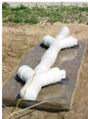
Εικόνα 2.15 Μέτρηση ηλεκτρικής αγωγιμότητας του εδάφους με ηλεκτρομαγνητική επαγωγή
