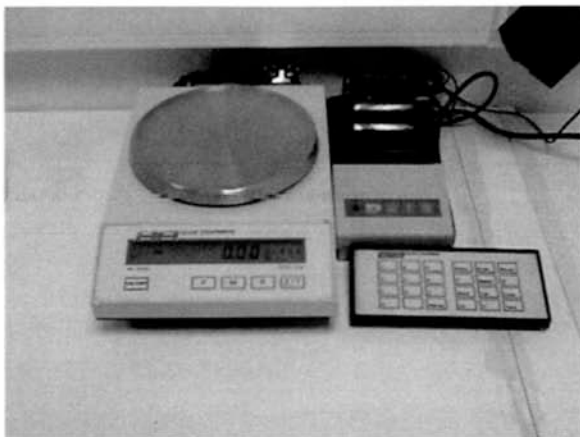
Εικόνα 3.6 Ψηφιακός ζυγός Adam Equipment, ακρίβειας 2 δεκαδικών ψηφίων
