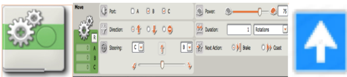
Εικόνα 14. Τυπική εντολή κίνησης ευθεία για το NXT (αριστερό και μεσαίο στιγμιότυπο). Η ίδια εντολή, παραμετροποιημένη και έτοιμη προς χρήση από τα παιδιά (δεξί στιγμιότυπο).
