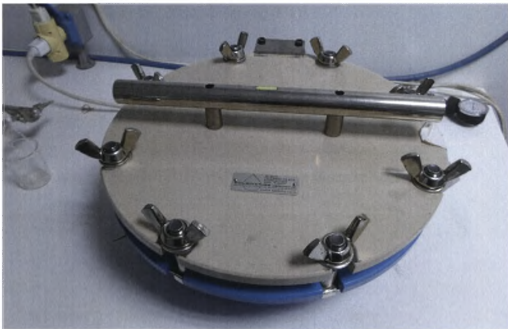
Εικόνα 4.7.3: Συσκευή RICHARD μέτρηση υδατοϊκανότητας και σημείου μόνιμης μάρανσης.
