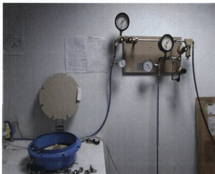
Εικόνα 4.7.1: Συσκευή RICHARD μέτρηση υδατοϊκανότητας και σημείου μόνιμης μάρανσης
