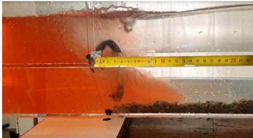
Εικόνα 7.48 Αρχή κίνησης ρεύματος βαρύτητας \rho=1080 \text{ kg/m}^3 για H=17.5\text{cm}
