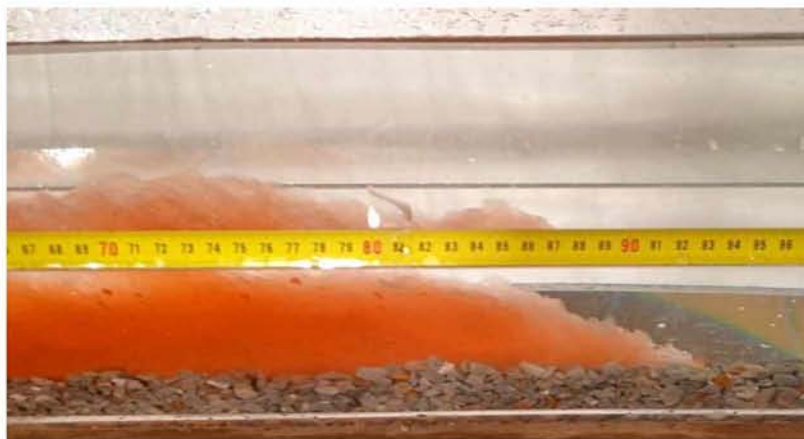
Εικόνα 7.49 Μέση κίνησης ρεύματος βαρύτητας \rho=1080 \text{ kg/m}^3 για H=17.5\text{cm}
