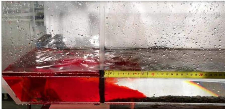
Εικόνα 7.24 Αρχή κίνησης ρεύματος βαρύτητας \rho=1050\text{ kg/m}^3 για H=10\text{cm}
