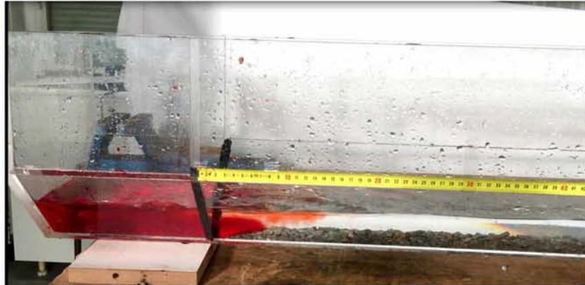
Εικόνα 7.9 Αρχή κίνησης ρεύματος βαρύτητας \rho=1050\text{ kg/m}^3 για H=5\text{cm}
