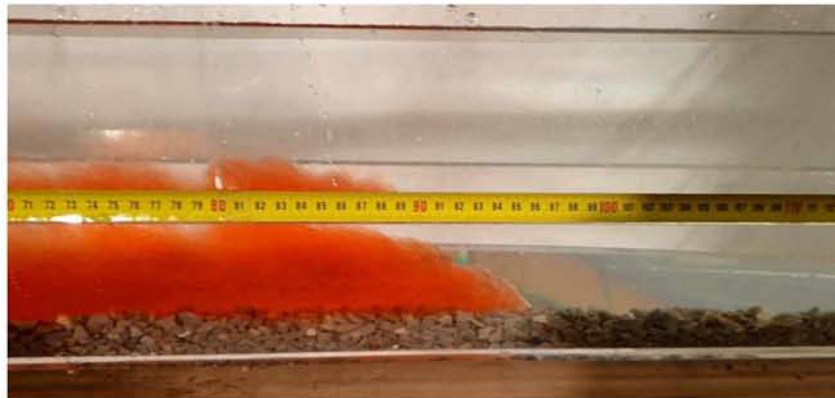
Εικόνα 7.40 Μέση κίνησης ρεύματος βαρύτητας \rho=1050\text{ kg/m}^3 για H=17.5\text{cm}
