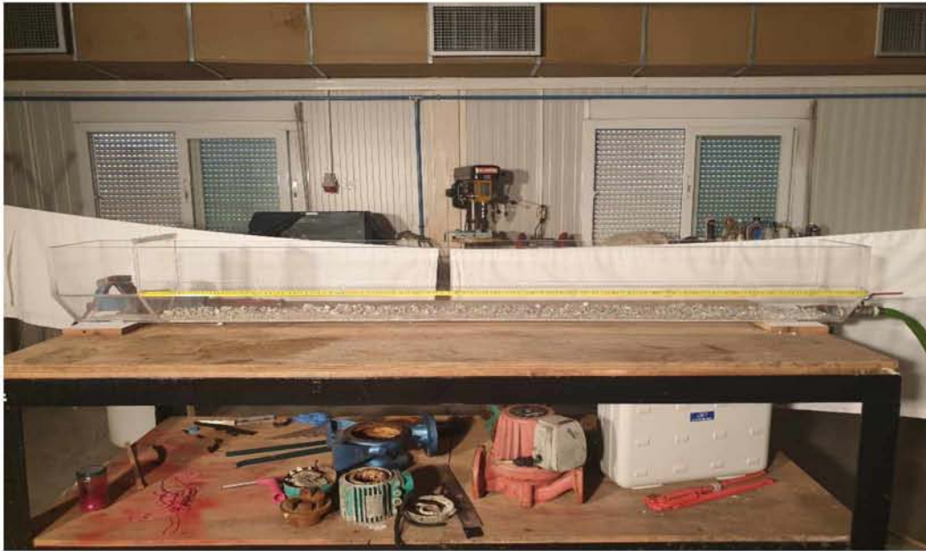
Εικόνα 7.1 Γυάλινη δεξαμενή μήκους 205cm , πλάτους 5cm στο κάτω μέρος και 23cm στο άνω
