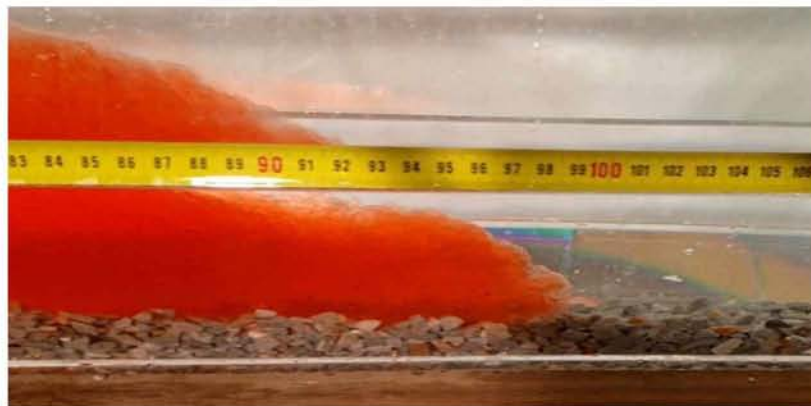
Εικόνα 7.55 Μέση κίνησης ρεύματος βαρύτητας \rho=1050\text{ kg/m}^3 για H=25\text{cm}
