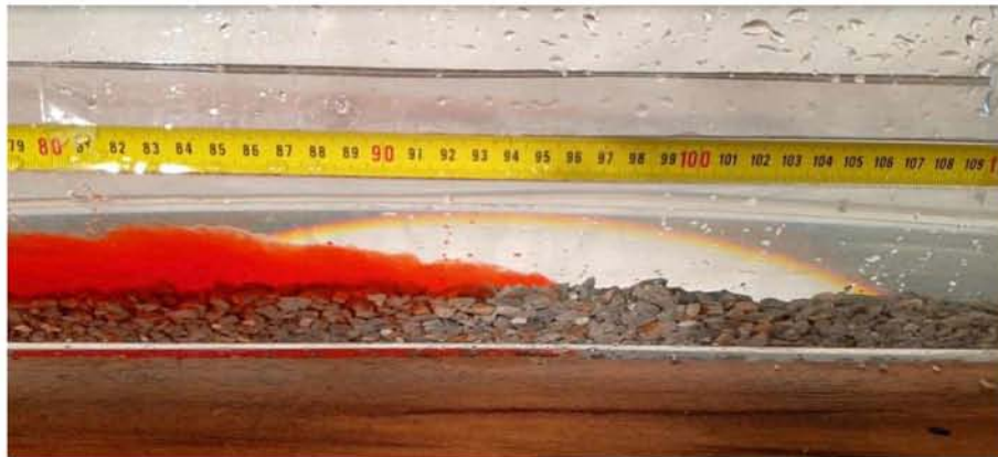
Εικόνα 7.28 Μέση κίνησης ρεύματος βαρύτητας \rho=1060 \text{ kg/m}^3 για H=10\text{cm}
