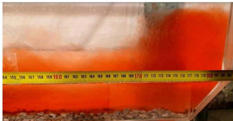
Εικόνα 7.56 Τέλος κίνησης ρεύματος βαρύτητας \rho=1050\text{ kg/m}^3 για H=25\text{cm}
