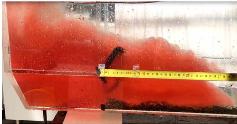
Εικόνα 7.66 Αρχή κίνησης ρεύματος βαρύτητας \rho=1090 \text{ kg/m}^3 για H=25\text{cm}
