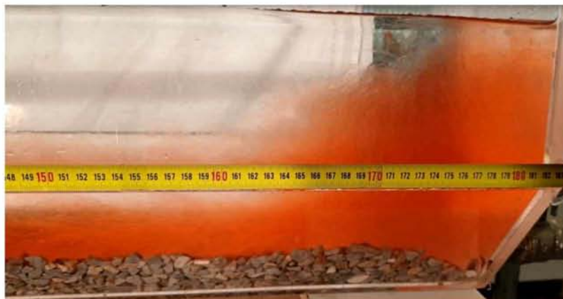
Εικόνα 7.53 Τέλος κίνησης ρεύματος βαρύτητας \rho=1090 \text{ kg/m}^3 για H=17.5\text{cm}
