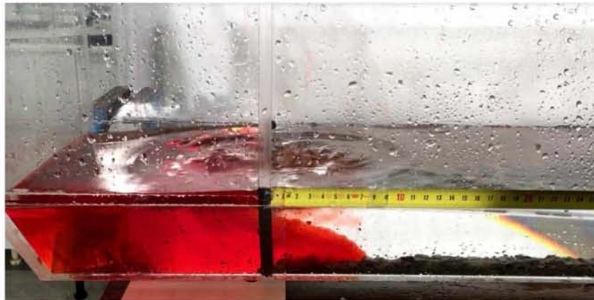
Εικόνα 7.27 Αρχή κίνησης ρεύματος βαρύτητας \rho=1060 \text{ kg/m}^3 για H=10\text{cm}
