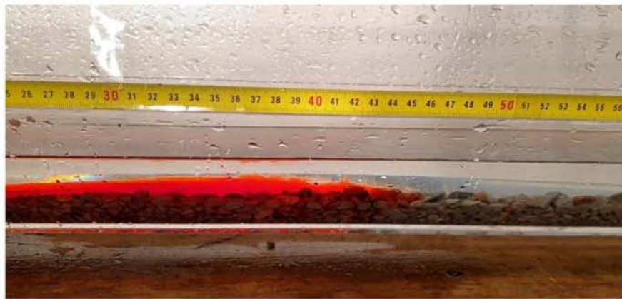
Εικόνα 7.19 Μέση κίνησης ρεύματος βαρύτητας \rho=1080 \text{ kg/m}^3 για H=5\text{cm}
