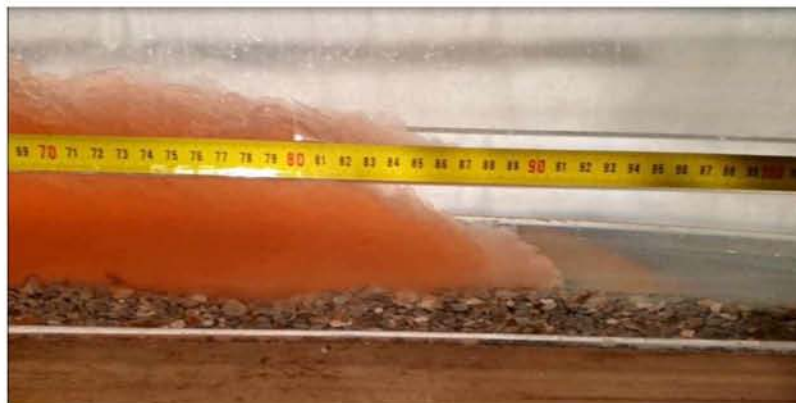
Εικόνα 7.64 Μέση κίνησης ρεύματος βαρύτητας \rho=1080 \text{ kg/m}^3 για H=25\text{cm}
