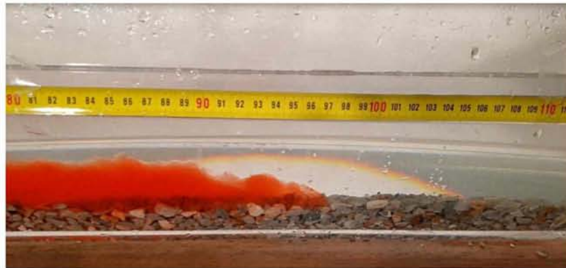
Εικόνα 7.37 Μέση κίνησης ρεύματος βαρύτητας \rho=1090 \text{ kg/m}^3 για H=10\text{cm}
