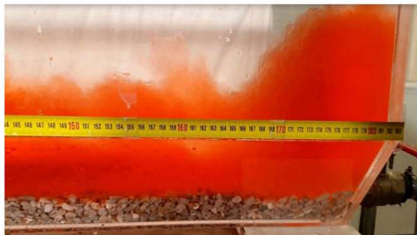
Εικόνα 7.68 Τέλος κίνησης ρεύματος βαρύτητας \rho=1090 \text{ kg/m}^3 για H=25\text{cm}
