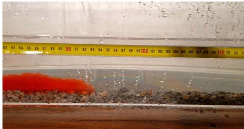
Εικόνα 7.34 Μέση κίνησης ρεύματος βαρύτητας \rho=1080 \text{ kg/m}^3 για H=10\text{cm}
