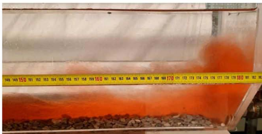
Εικόνα 7.41 Τέλος κίνησης ρεύματος βαρύτητας \rho=1050\text{ kg/m}^3 για H=17.5\text{cm}
