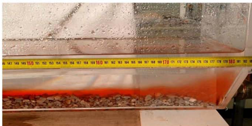
Εικόνα 7.29 Τέλος κίνησης ρεύματος βαρύτητας \rho=1060 \text{ kg/m}^3 για H=10\text{cm}
