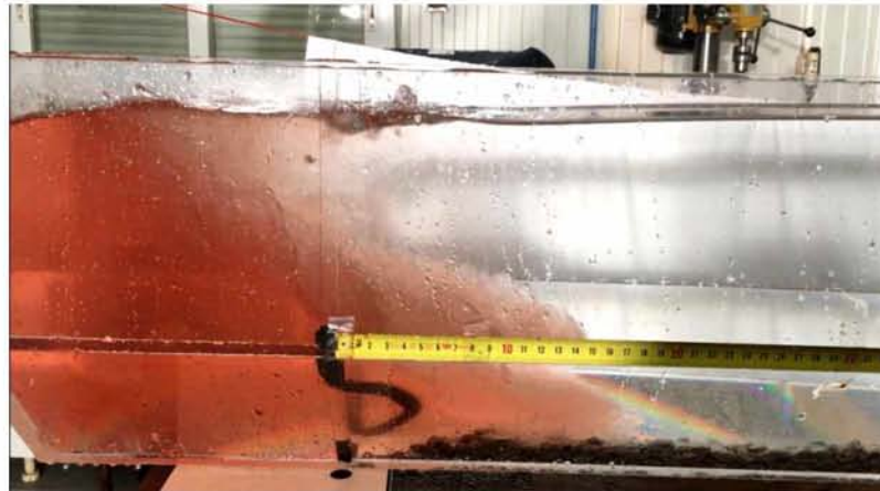
Εικόνα 7.63 Αρχή κίνησης ρεύματος βαρύτητας \rho=1080 \text{ kg/m}^3 για H=25\text{cm}
