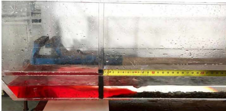
Εικόνα 7.21 Αρχή κίνησης ρεύματος βαρύτητας \rho=1090 \text{ kg/m}^3 για H=5\text{cm}
