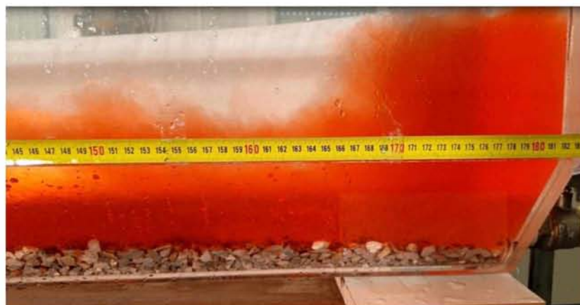
Εικόνα 7.62 Τέλος κίνησης ρεύματος βαρύτητας \rho=1070 \text{ kg/m}^3 για H=25\text{cm}
