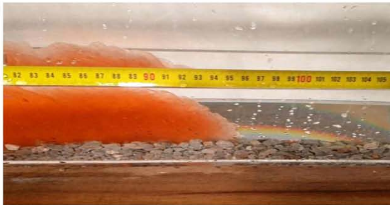
Εικόνα 7.46 Μέση κίνησης ρεύματος βαρύτητας \rho=1070 \text{ kg/m}^3 για H=17.5\text{cm}
