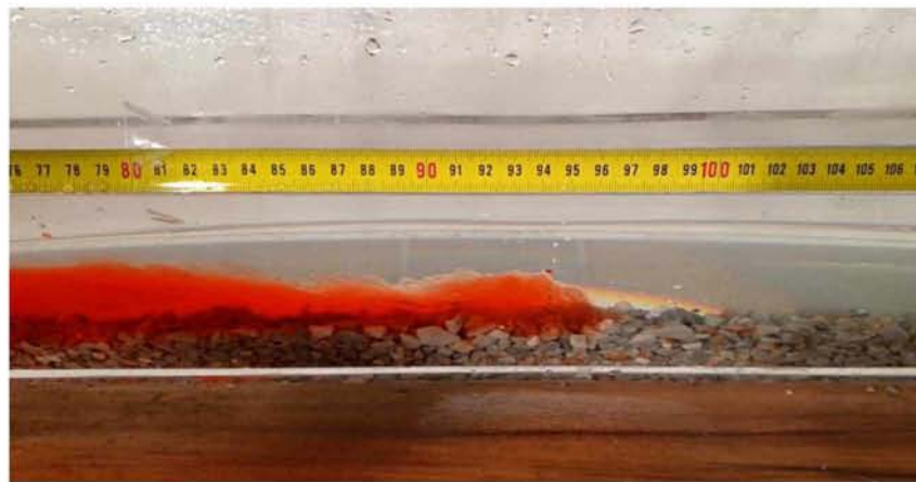
Εικόνα 7.31 Μέση κίνησης ρεύματος βαρύτητας \rho=1070 \text{ kg/m}^3 για H=10\text{cm}
