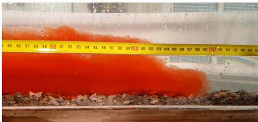
Εικόνα 7.61 Μέση κίνησης ρεύματος βαρύτητας \rho=1070 \text{ kg/m}^3 για H=25\text{cm}
