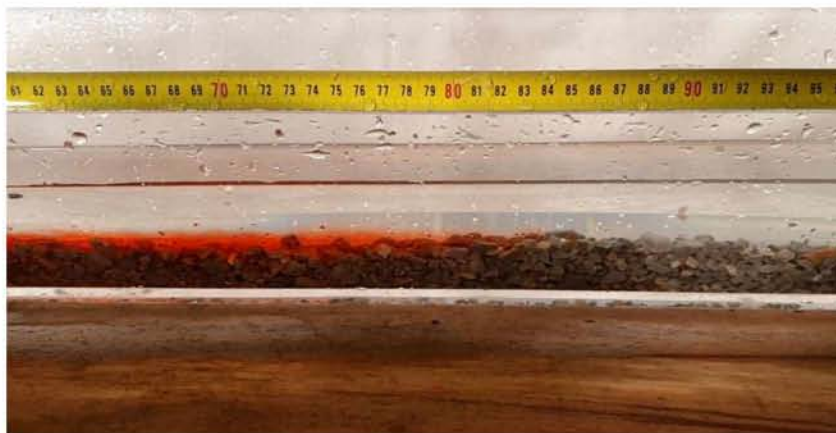
Εικόνα 7.17 Τέλος κίνησης ρεύματος βαρύτητας \rho=1070 \text{ kg/m}^3 για H=5\text{cm}
