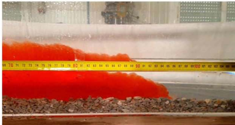
Εικόνα 7.58 Μέση κίνησης ρεύματος βαρύτητας \rho=1060 \text{ kg/m}^3 για H=25\text{cm}
