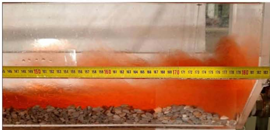
Εικόνα 7.44 Τέλος κίνησης ρεύματος βαρύτητας \rho=1060 \text{ kg/m}^3 για H=17.5\text{cm}
