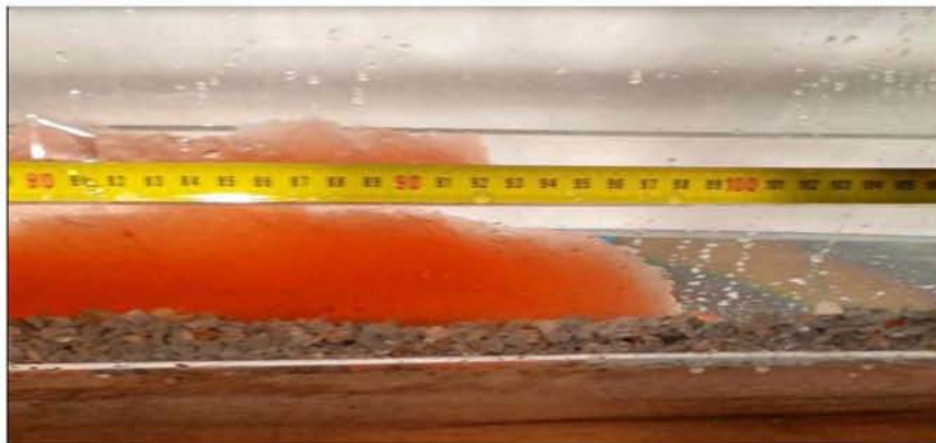
Εικόνα 7.52 Μέση κίνησης ρεύματος βαρύτητας \rho=1090 \text{ kg/m}^3 για H=17.5\text{cm}
