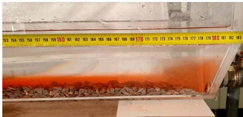
Εικόνα 7.38 Τέλος κίνησης ρεύματος βαρύτητας \rho=1090 \text{ kg/m}^3 για H=10\text{cm}
