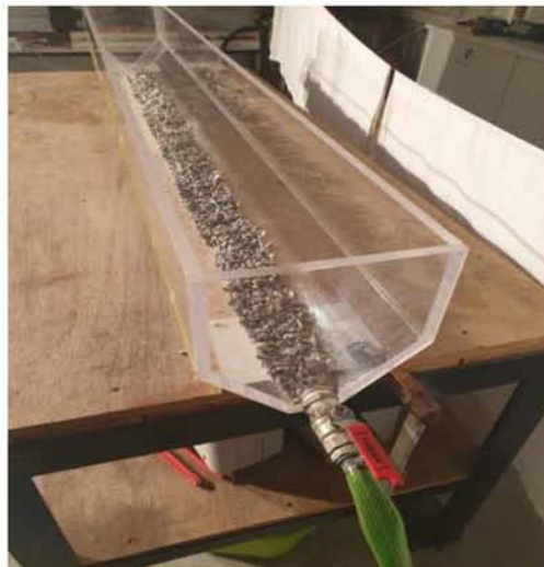
Εικόνα 7.5 Προφίλ εξόδου γυάλινης δεξαμενής μήκους 205cm
