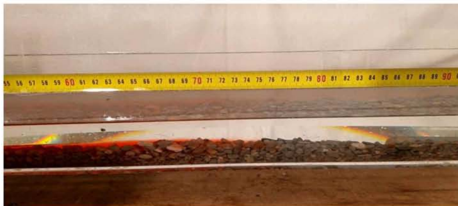
Εικόνα 7.14 Τέλος κίνησης ρεύματος βαρύτητας \rho=1060 \text{ kg/m}^3 για H=5\text{cm}
