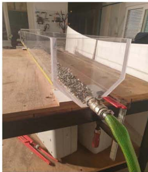
Εικόνα 7.4 Έξοδος γυάλινης δεξαμενής μήκους 205cm
