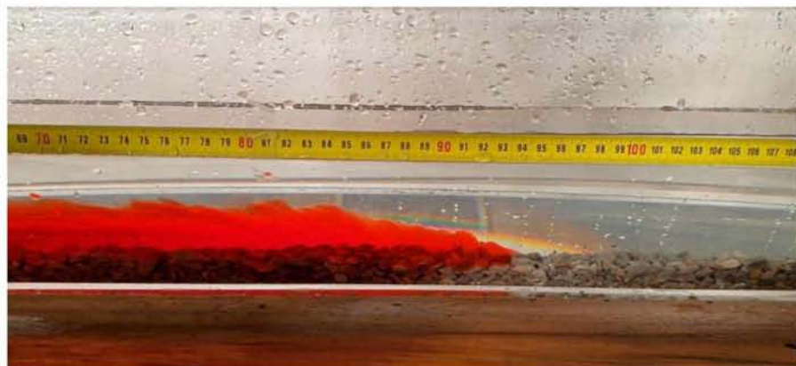
Εικόνα 7.25 Μέση κίνησης ρεύματος βαρύτητας \rho=1050\text{ kg/m}^3 για H=10\text{cm}
