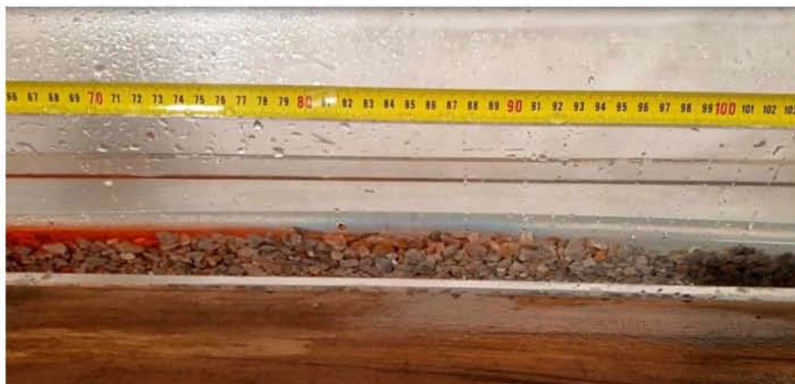
Εικόνα 7.23 Τέλος κίνησης ρεύματος βαρύτητας \rho=1090 \text{ kg/m}^3 για H=5\text{cm}
