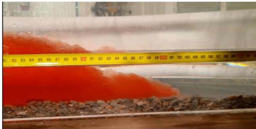
Εικόνα 7.67 Μέση κίνησης ρεύματος βαρύτητας \rho=1090 \text{ kg/m}^3 για H=25\text{cm}
