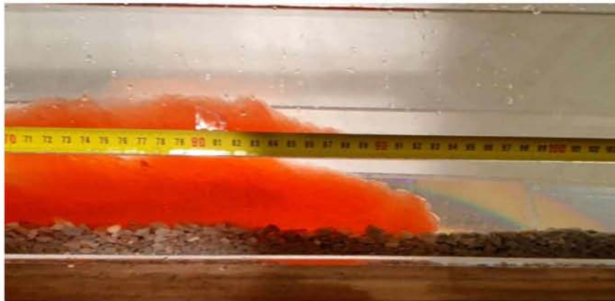
Εικόνα 7.43 Μέση κίνησης ρεύματος βαρύτητας \rho=1060 \text{ kg/m}^3 για H=17.5\text{cm}
