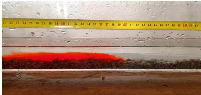
Εικόνα 7.16 Μέση κίνησης ρεύματος βαρύτητας \rho=1070 \text{ kg/m}^3 για H=5\text{cm}
