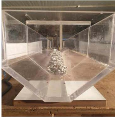
Εικόνα 7.6 Προφίλ στρώματος χαλικιού πάχους 2cm
