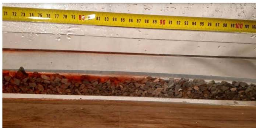
Εικόνα 7.20 Τέλος κίνησης ρεύματος βαρύτητας \rho=1080 \text{ kg/m}^3 για H=5\text{cm}
