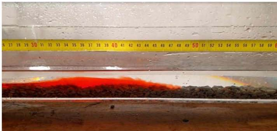
Εικόνα 7.22 Μέση κίνησης ρεύματος βαρύτητας \rho=1090 \text{ kg/m}^3 για H=5\text{cm}
