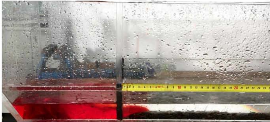
Εικόνα 7.15 Αρχή κίνησης ρεύματος βαρύτητας \rho=1070 \text{ kg/m}^3 για H=5\text{cm}
