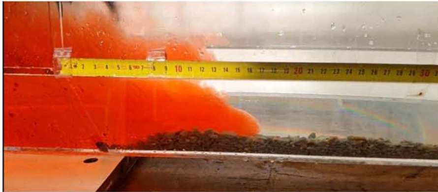
Εικόνα 7.42 Αρχή κίνησης ρεύματος βαρύτητας \rho=1060 \text{ kg/m}^3 για H=17.5\text{cm}
