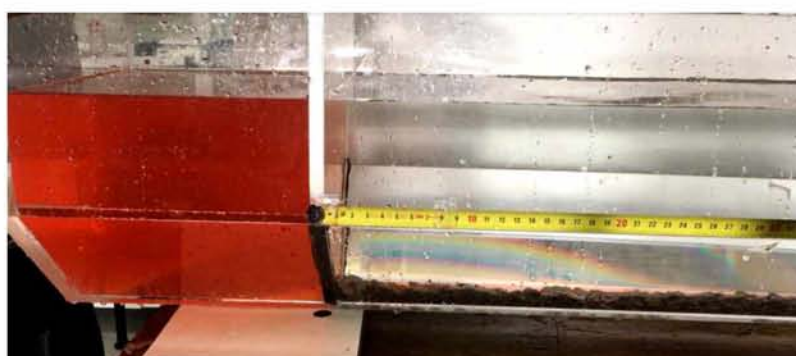
Εικόνα 3.4.3 Δεξαμενή με ύψος υγρών H=17.5\text{cm}
