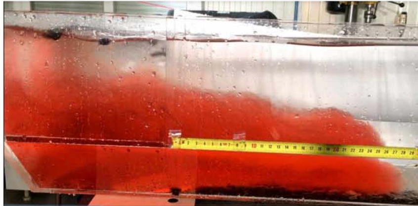
Εικόνα 7.60 Αρχή κίνησης ρεύματος βαρύτητας \rho=1070 \text{ kg/m}^3 για H=25\text{cm}
