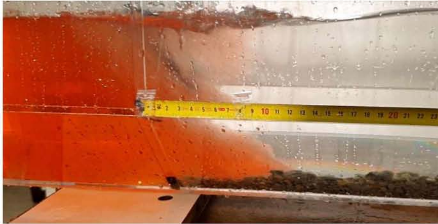
Εικόνα 7.45 Αρχή κίνησης ρεύματος βαρύτητας \rho=1070 \text{ kg/m}^3 για H=17.5\text{cm}
