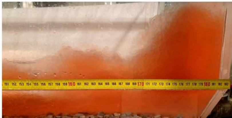
Εικόνα 7.65 Τέλος κίνησης ρεύματος βαρύτητας \rho=1080 \text{ kg/m}^3 για H=25\text{cm}
