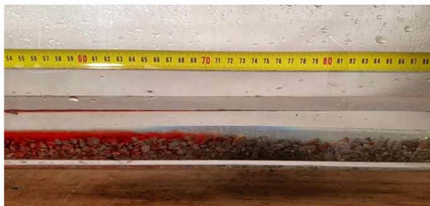
Εικόνα 7.11 Τέλος κίνησης ρεύματος βαρύτητας \rho=1050\text{ kg/m}^3 για H=5\text{cm}
