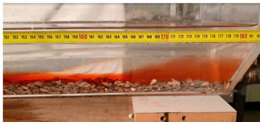
Εικόνα 7.32 Τέλος κίνησης ρεύματος βαρύτητας \rho=1070 \text{ kg/m}^3 για H=10\text{cm}
