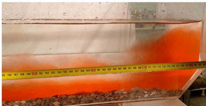
Εικόνα 7.50 Τέλος κίνησης ρεύματος βαρύτητας \rho=1080 \text{ kg/m}^3 για H=17.5\text{cm}
