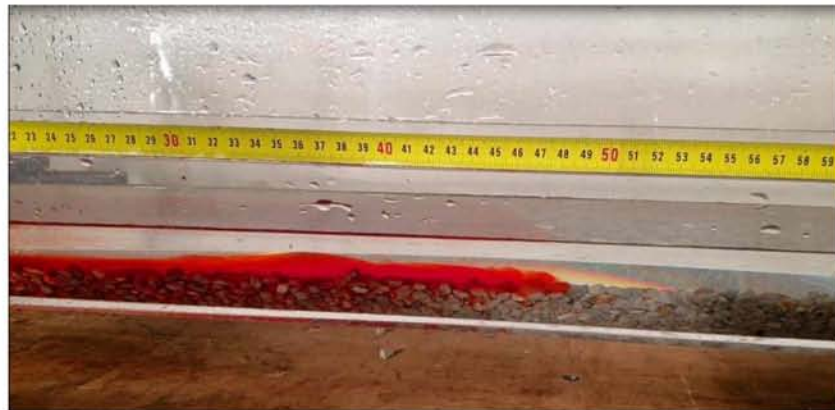
Εικόνα 7.10 Μέση κίνησης ρεύματος βαρύτητας \rho=1050\text{ kg/m}^3 για H=5\text{cm}
