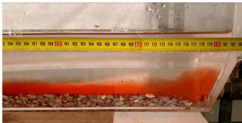
Εικόνα 7.35 Τέλος κίνησης ρεύματος βαρύτητας \rho=1080 \text{ kg/m}^3 για H=10\text{cm}
