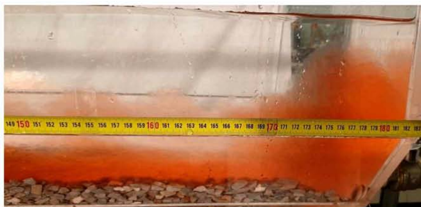
Εικόνα 7.47 Τέλος κίνησης ρεύματος βαρύτητας \rho=1070 \text{ kg/m}^3 για H=17.5\text{cm}
