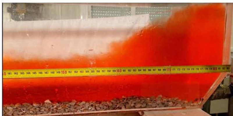
Εικόνα 7.59 Τέλος κίνησης ρεύματος βαρύτητας \rho=1060 \text{ kg/m}^3 για H=25\text{cm}
