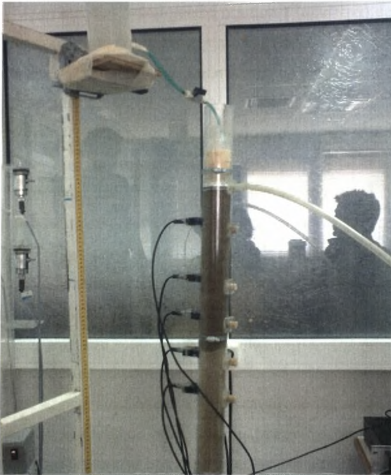
Σχήμα 3.6 Πειραματική διάταξη για τη μελέτη της αθροιστικής διήθησης
