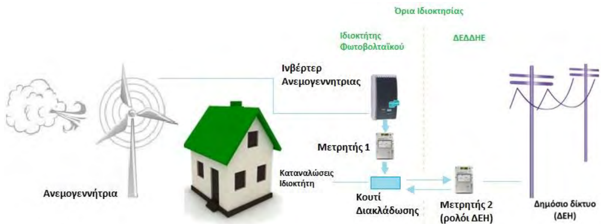
Σχήμα 6.3: Σύνδεση συστήματος ανεμογεννήτριας με το δίκτυο
