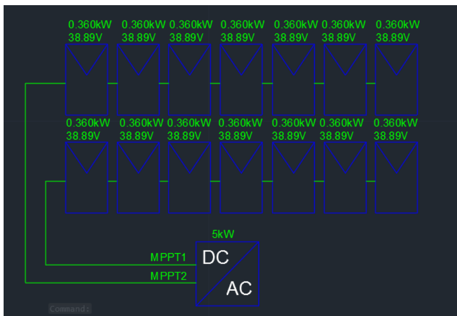
Σχήμα 5.2: Μονογραμμικό διάγραμμα συνδεσμολογίας φωτοβολταϊκών με τον αντιστροφέα
