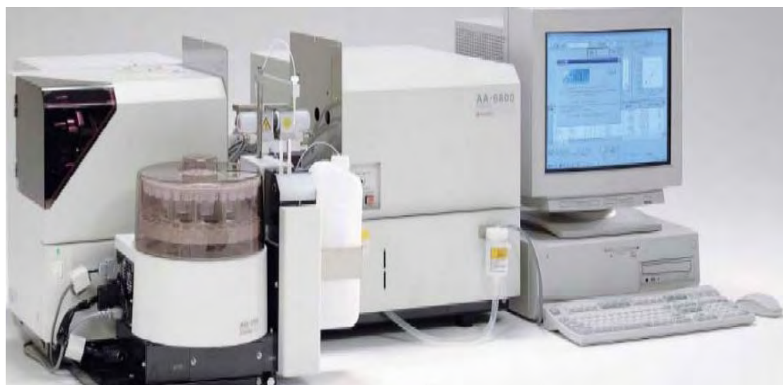
Εικόνα3.4.1: Ατομική απορρόφηση σε φούρνο με γραφίτη (Graphite Furnace GFAAS)
