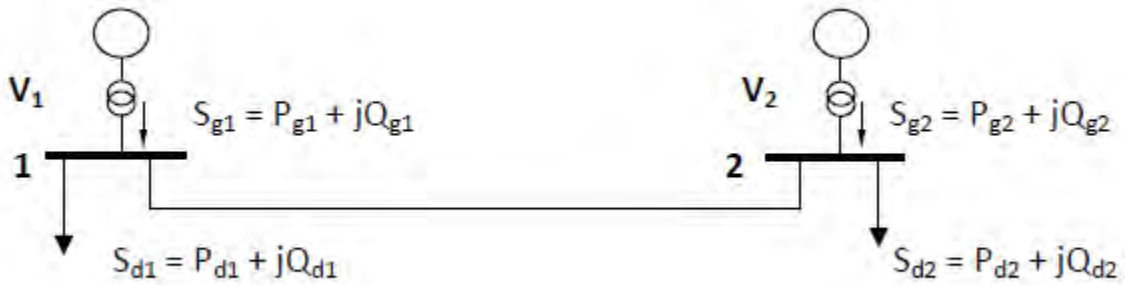
Σχήμα 1: Δίκτυο δύο ζυγών για την εξαγωγή των εξισώσεων ροής φορτίου
