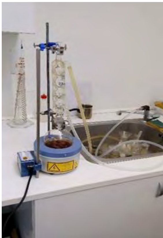
Εικόνα 3.2 Διάταξη εκχύλισης με θερμομανδύα
