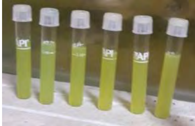
Εικόνα 7: Μέτρηση αμμωνίας στα ενυδρεία
