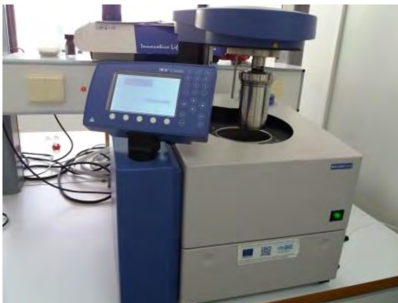
Εικόνα 14: Συσκευή Αδιαβατικού Θερμιδομέτρου
