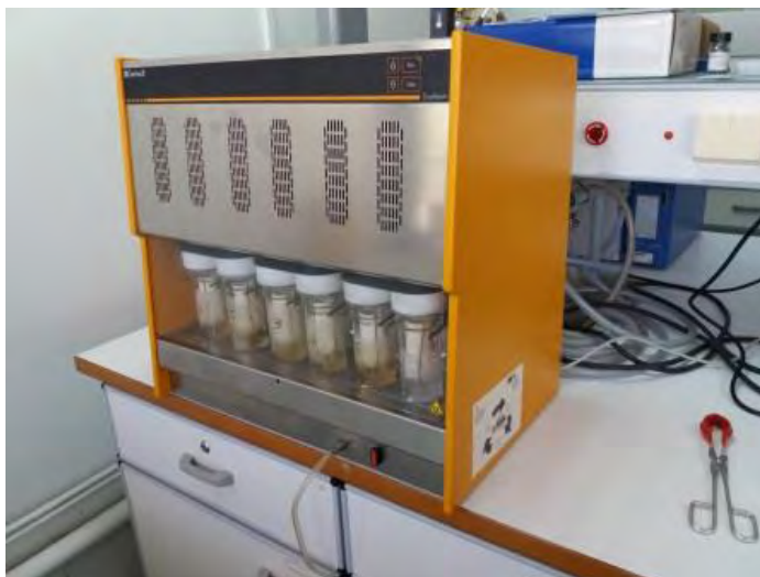
Εικόνα 13: Συσκευή εκχύλισης λιπαρών ουσιών Soxhlet
