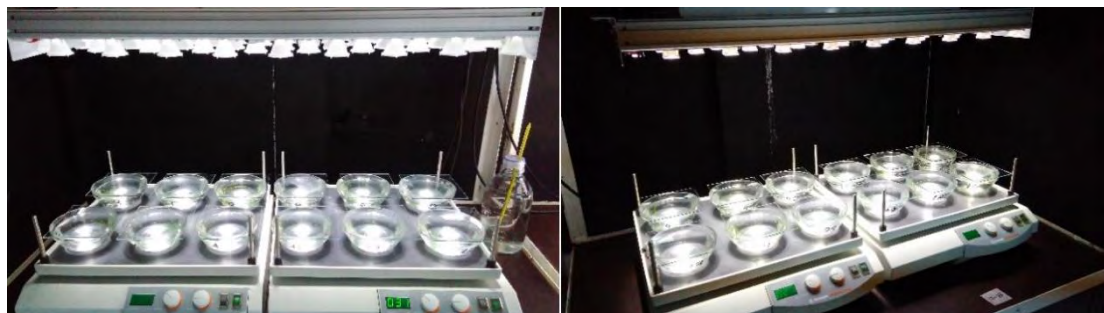
Εικόνα 16. Πειραματική διάταξη στις τέσσερις (4) συνθήκες (από αριστερά προς τα δεξιά: C1: αλατότητα 9 και 50 \mu\text{mol} φωτονίων \text{m}^{-2} \text{s}^{-1} , C2: αλατότητα 19 και 50 \mu\text{mol} φωτονίων \text{m}^{-2} \text{s}^{-1} , C3: αλατότητα 9 και 200 \mu\text{mol} φωτονίων \text{m}^{-2} \text{s}^{-1} , C4: αλατότητα 19 και 200 \mu\text{mol} φωτονίων \text{m}^{-2} \text{s}^{-1} ).
