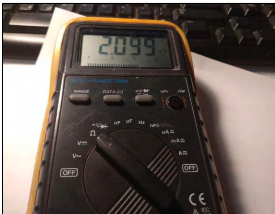
Εικόνα 34 Ωμομέτρηση χωρίς εφίδρωση
