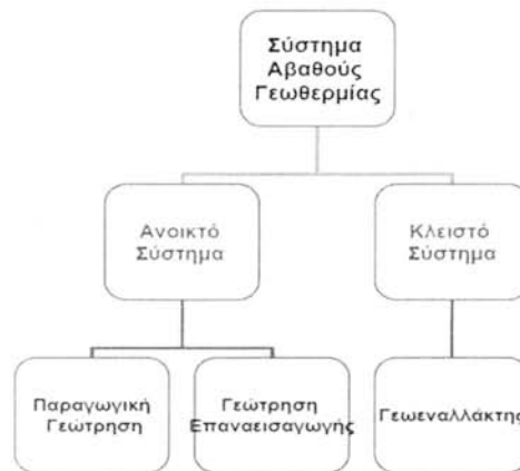
Σχήμα 2.13: Κατηγορίες συστημάτων αβαθούς γεωθερμίας (Μιχόπουλος, 2011)
