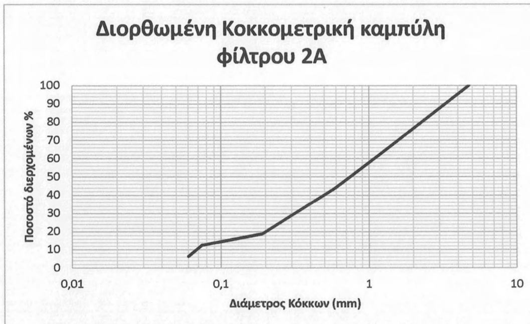
Σχήμα 2.12 Διορθωμένη κοκκομετρική καμπύλη φίλτρου ζώνης 2, η οποία λαμβάνεται ως καμπύλη υλικού βάσης για τον σχεδιασμό του φίλτρου ζώνης 3.
