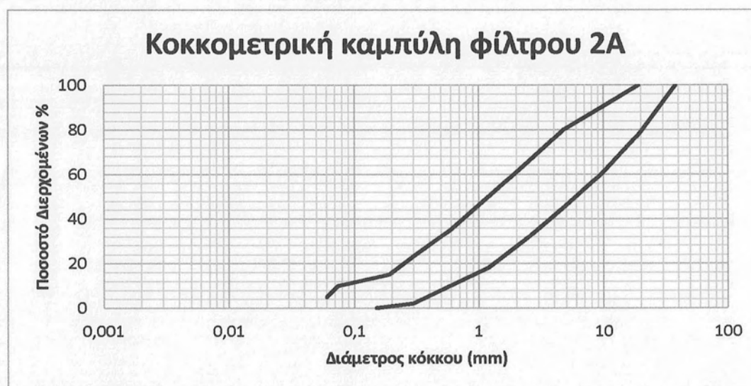
Σχήμα 2.6 Διάγραμμα κοκκομετρικής διαβάθμισης υλικού φίλτρου (Ζώνη 2) φράγματος Σμοκόβου
