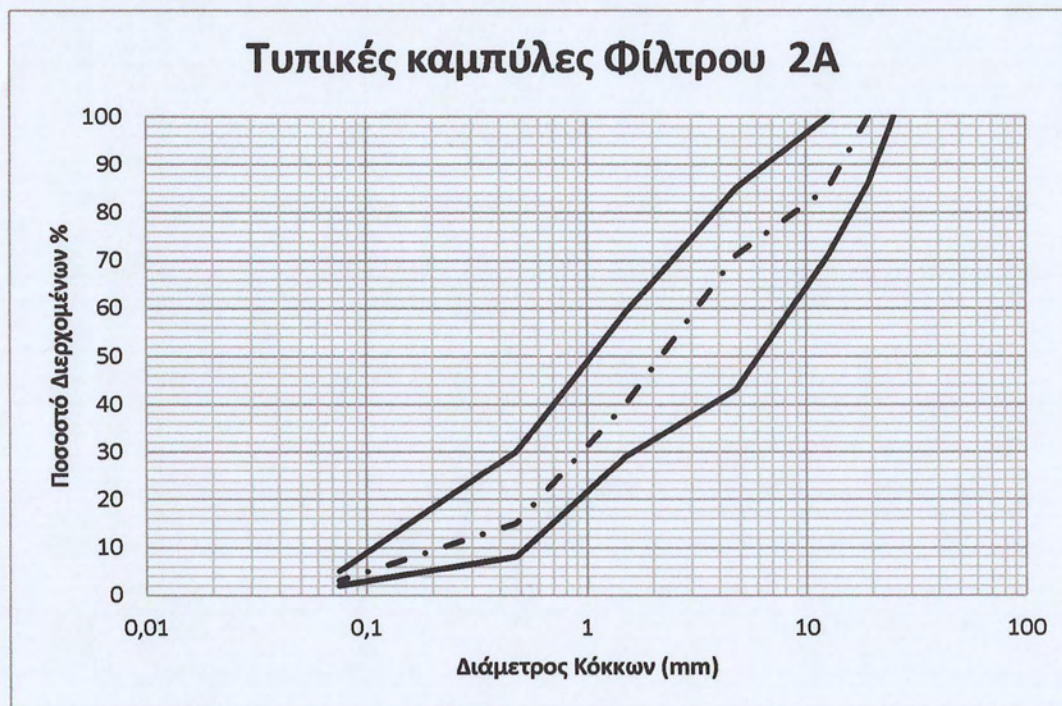
Σχήμα 2.9 Τυπικές κοκκομετρικές καμπύλες φίλτρου ζώνης 2 όπως προτείνονται από τον καθηγητή Ν.Ι. Μουτάφη.
