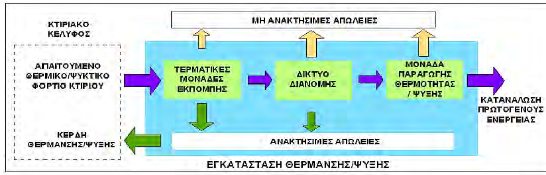
Εικόνα 3: Διάγραμμα διαδικασίας λειτουργίας εγκατάστασης θέρμανσης/ψύξης.
