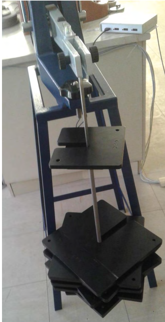
Εικόνα 3.6 Κατάλληλη τοποθέτηση φορτίων
