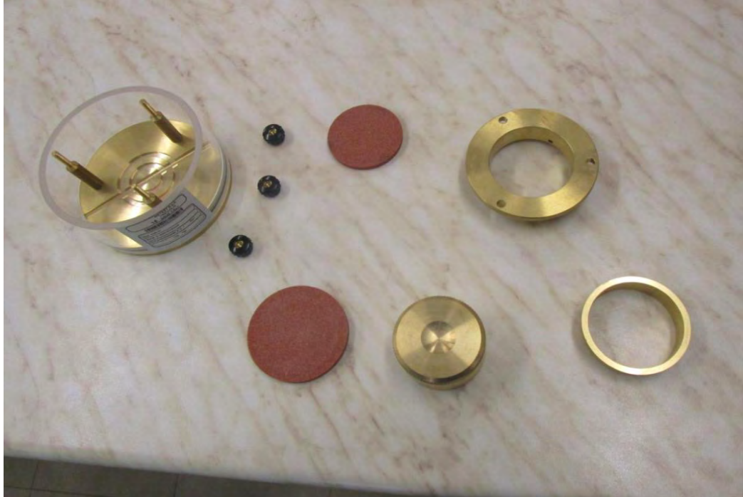
Εικόνα 3.2 Πορώδεις δίσκοι και κυψέλη στερεοποίησης
