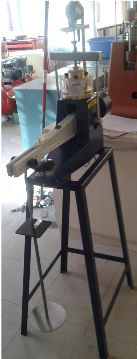
Εικόνα 3.5 Τοποθέτηση πρώτου φορτίου φόρτισης
