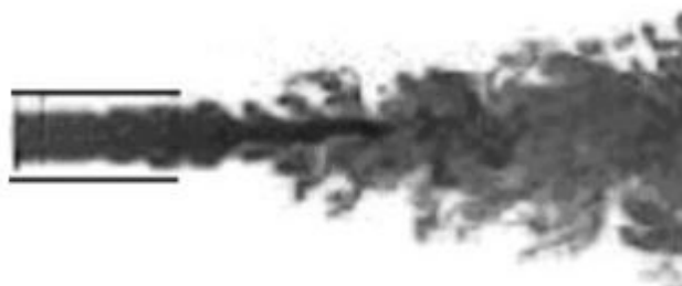
Εικόνα 6 : Έγχυση ενός υγρού μέσα σ'ένα άλλο μέσα από ακροφύσιο
