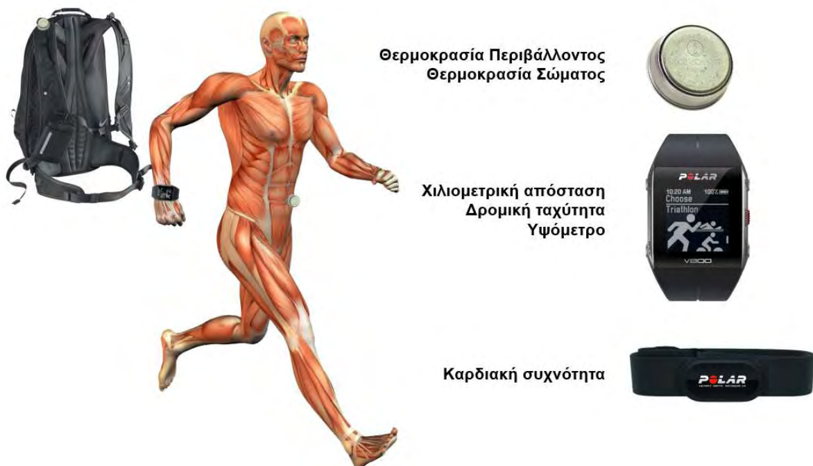
Εικόνα 8. Αισθητήρες καταγραφής δεδομένων πεδίου από τον εθελοντή αθλητή στον MdS.
