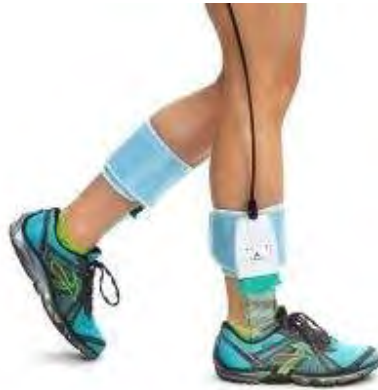
Εικόνα 10. Σύνδεση των cuffs με τους αισθητήρες πίεσης του Fscan και στη συνέχεια σύνδεση του μηχανήματος, το οποίο ήταν τοποθετημένο γύρω από τη μέση του ασθενούς, μέσω καλωδίων LAN
