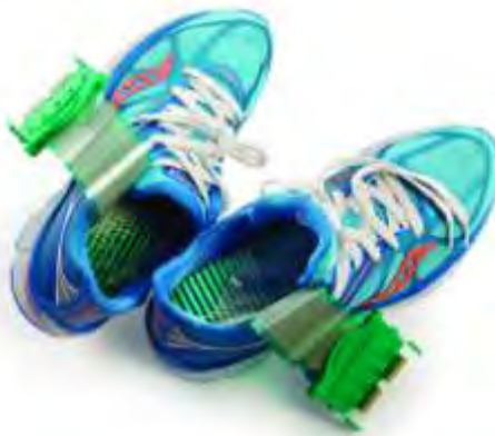
Εικόνα 6. Τοποθέτηση αισθητήρων συστήματος Fscan μέσα στο παπούτσι
