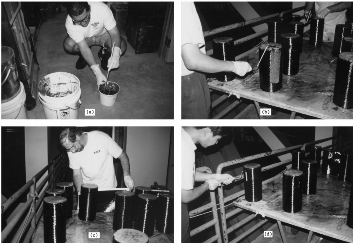
Σχήμα 3.19 : Διαδικασία τοποθέτησης ΙΟΠ τύπου CFRP σε κυλινδρικά δοκίμια άοπλου σκυροδέματος a) ανάμιξη εποξειδικής ρητίνης, b) τοποθέτηση κόλλας στην επιφάνεια του δοκιμίου, c) τοποθέτηση φύλλου CFRP, d) σφράγιση επικάλυψης. [41]
