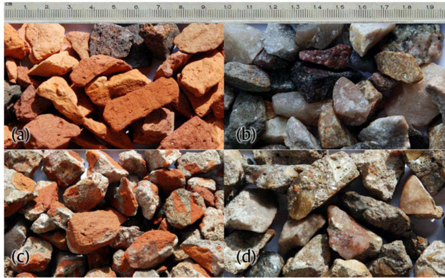
Σχήμα 3.15 : Αδρανή μεγέθους 12 – 19 mm χρησιμοποιηθέντα στο μείγμα σκυροδέματος. α) πρωτογενή αδρανή από σπλινθοδομικά υλικά, β) πρωτογενή αδρανή από πέτρα, γ) ανακυκλωμένα αδρανή από σπλινθοδομικά υλικά, δ) ανακυκλωμένα αδρανή από πέτρα [40]
