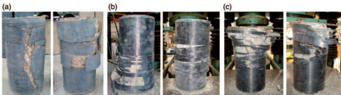
Σχήμα 3.24 : Αστοχία δοκιμίων με επικάλυψη CFRP. Σκυρόδεμα με διαφορετική αντοχή, a) f_{co} = 26 MPa, b) f_{co} = 50 MPa, c) f_{co} = 62 MPa, [45]
