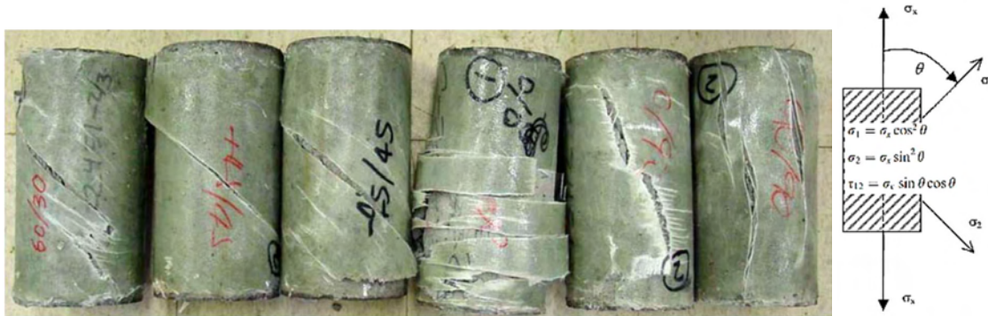
Σχήμα 3.25 : Αστοχία δοκιμίων με επικάλυψη ΙΟΠ με διαφορετικό προσανατολισμό ινών - σχέση τάσεων υπό γωνία με τον διαμήκη προσανατολισμό του δοκιμίου [46]
