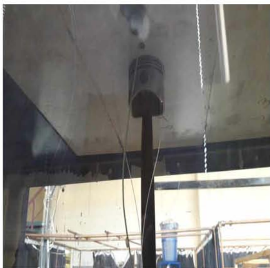
Σχήμα 3.2 Ο πείρος με το έμβολο
