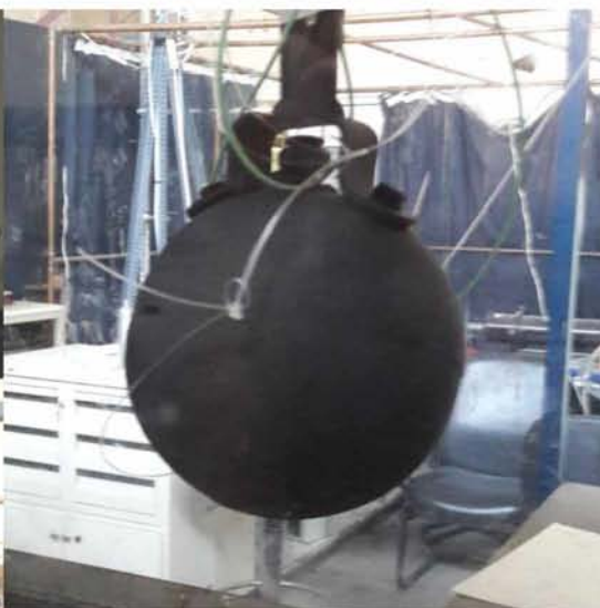
Σχήμα 3.3 Η σφαίρα συνδεδεμένη με τη μπιέλα
