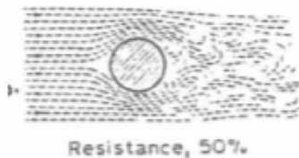
Σχήμα 2.23 Η αντίσταση της σφαίρας μέσα σε ροή αέρα (50%) (Ε. Σταπουντζής, 2013)
