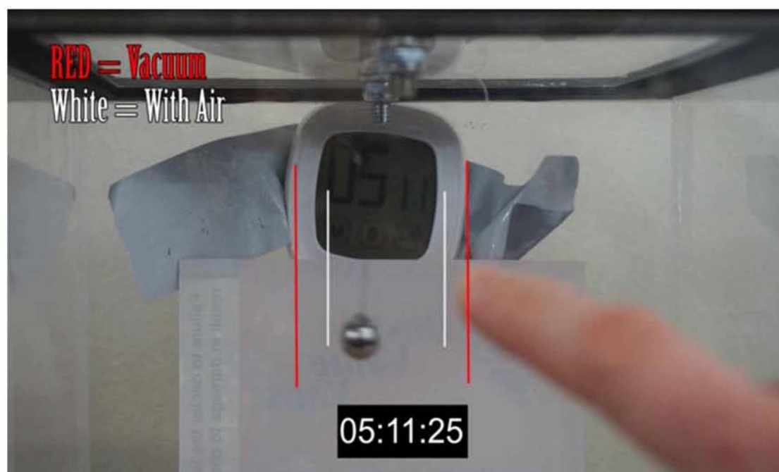
Σχήμα 7.1 Η διαφορά στο πλάτος της ταλάντωσης σε κανονικές συνθήκες και σε κενό αέρος
