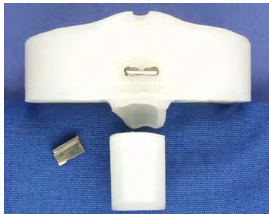
Εικ. 13-8 θραύση από εγχειρίδιο της ίδιας της εταιρίας
