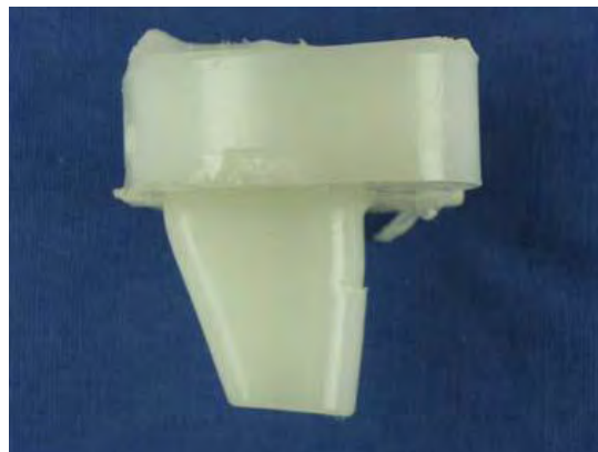
Εικ. 13-7 παραμόρφωση από εγχειρίδιο της ίδιας της εταιρίας
