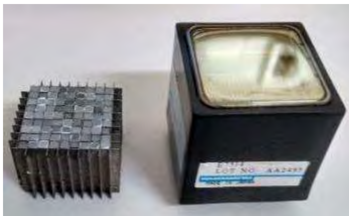
Σχήμα 7.13. Τελική συστοιχία κατευθυντήρα-σπινθηριστή δίπλα στον PSPMT
