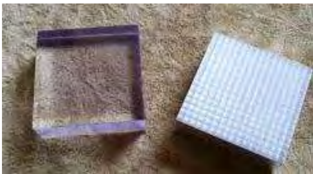
Σχήμα 3.2. Παράδειγμα ομογενή (αριστερά ) και διακριτοποιημένου σπινθηριστή (δεξιά)
