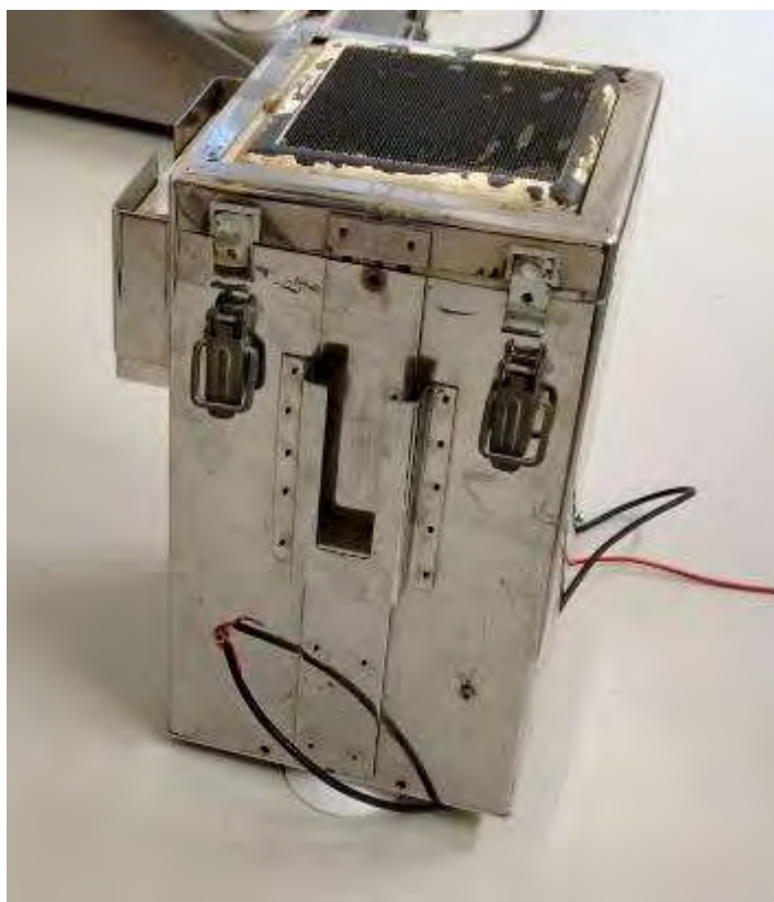
Σχήμα 4.8. Κεφαλή \gamma - κάμερας κυκλικού πεδίου 5''
